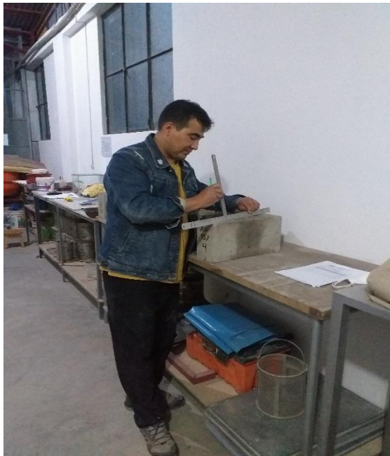
Figura N 06: Ejecución del proceso de pruebas de ensayo de alabeo a las unidades de albañilería de mesclado y elaboración de las unidades de albañilería con las dosificaciones de la ceniza de caña de azúcar.
