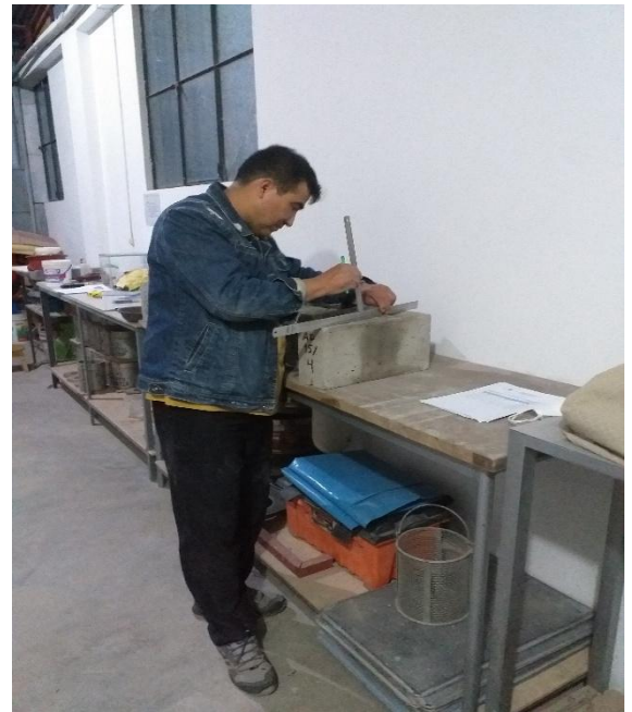
Figura N 06: Ejecución del proceso de pruebas de ensayo de alabeo a las unidades de albañilería de mesclado y elaboración de las unidades de albañilería con las dosificaciones de la ceniza de caña de azúcar.
