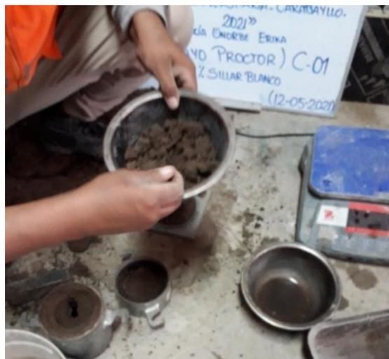
Fotografía 156. Muestra lista para el secado.
