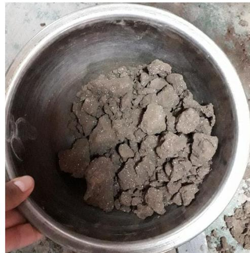
**Figura 31.** Muestra extraída del molde Proctor con el 6% de sillar blanco.
