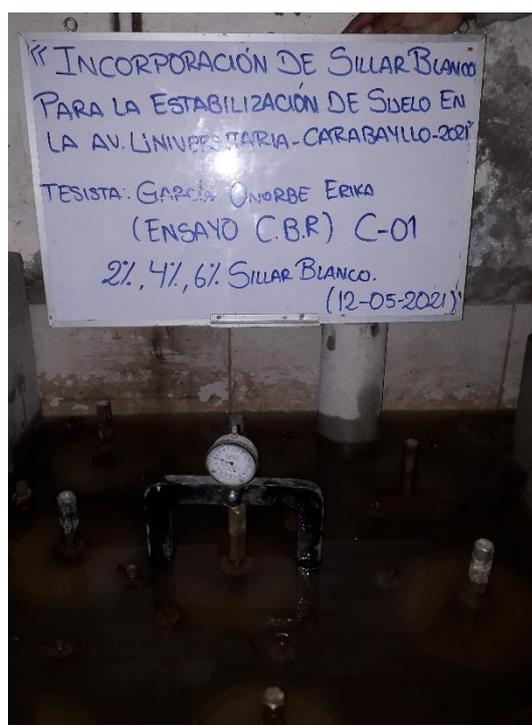
**Figura 32.** Moldes de CBR con la adición (2%, 4%, 6%) de sillar blanco sumergidos en la poza de saturación.
