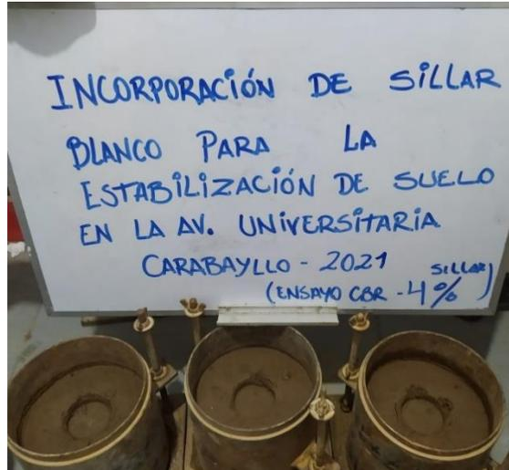
Fotografía 202. Moldes ensayados / 4% Sillar.
