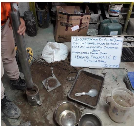
Fotografía 143. Extracción muestra del molde
