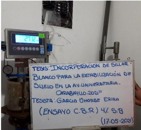
Fotografía 199. Ensayo C.B.R / 4% Sillar.
