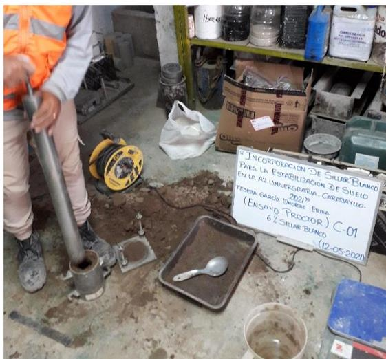
Fotografía 155. Extracción muestra del molde
