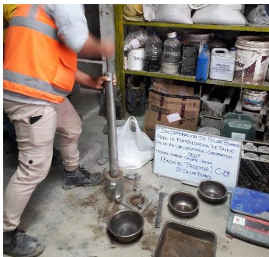
Fotografía 131. Extracción muestra del molde
