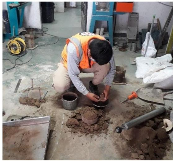
Fotografía 66. Muestra lista para el secado.
