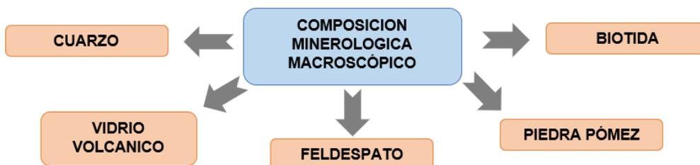
**Figura 7.** Composición Mineralógica Macroscópicamente
