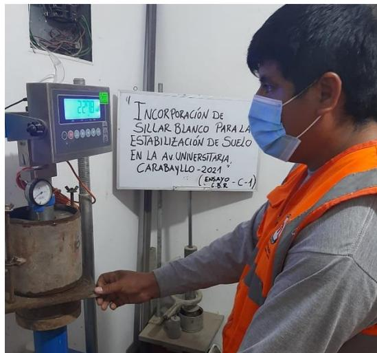
Fotografía 118. Ensayo C.B.R / C1.
