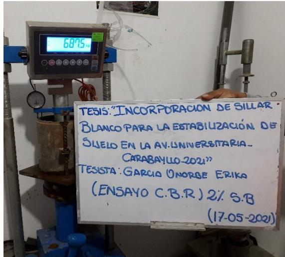
Fotografía 198. Ensayo C.B.R / 2% Sillar.
