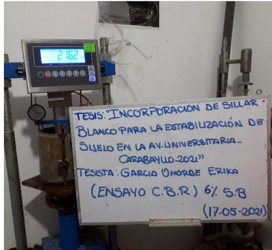
Fotografía 200. Ensayo C.B.R / 6% Sillar.
