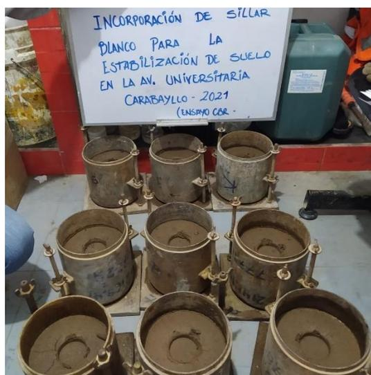
**Figura 34.** Ensayo de CBR con la incorporación de sillar blanco.
