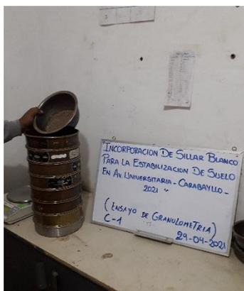
**Figura 25.** Ensayo de Granulometría de las 03 calicatas
