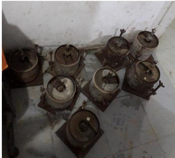
Fotografía 196. Moldes extraídos del tanque.
