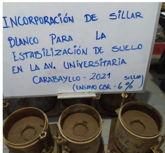
Fotografía 203. Moldes ensayados / 6% Sillar.
