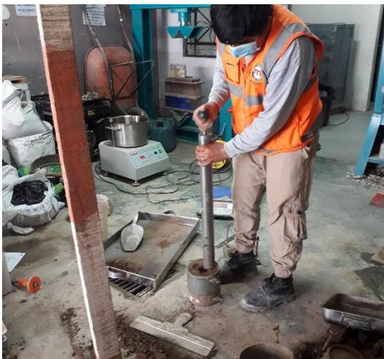
Fotografía 53. Extracción muestra del molde.
