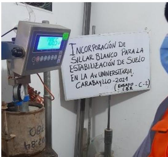
Fotografía 119. Ensayo C.B.R / C2.
