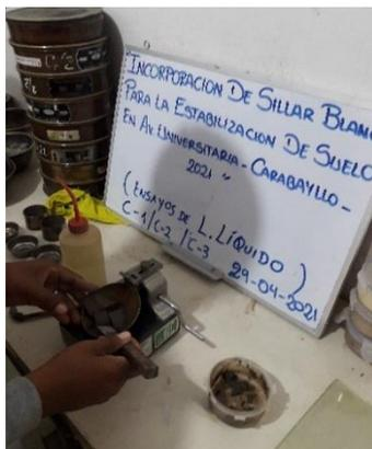
**Figura 26.** Ensayo de Límite Líquido de las 03 calicatas
