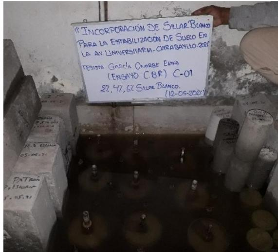
Fotografía 194. Sumergida de moldes C.B.R.
