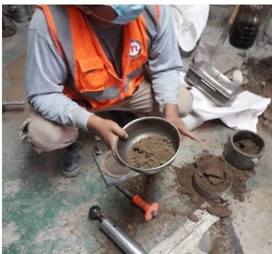
Fotografía 78. Muestra lista para el secado.
