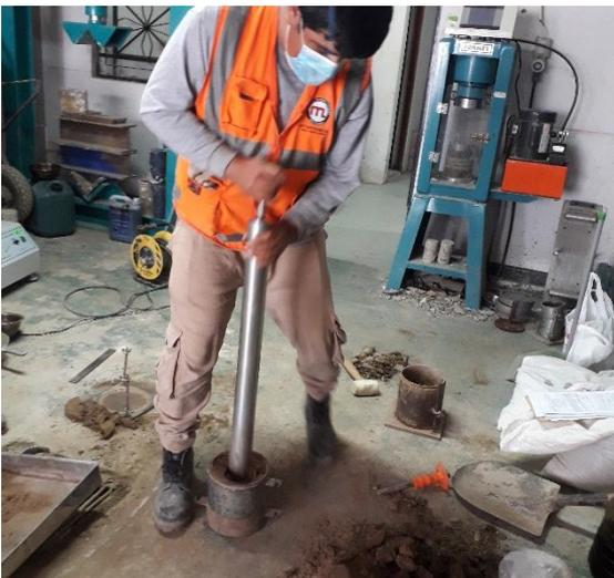
Fotografía 65. Extracción muestra del molde.
