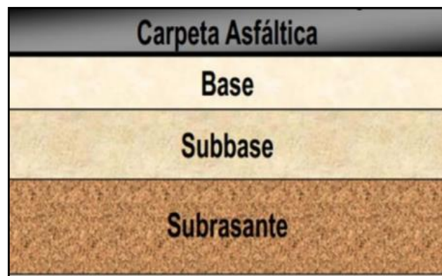
Figura 2. Sección típica de un pavimento flexible
