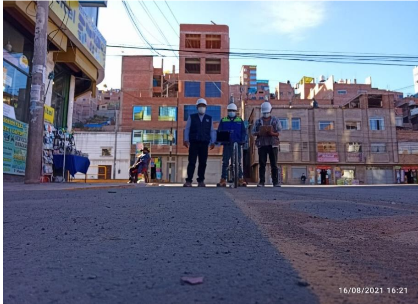
Figura 7. Empleo del equipo rugosímetro de MERLÍN, Tramo 0+000 Fuente: Elaboración propia
