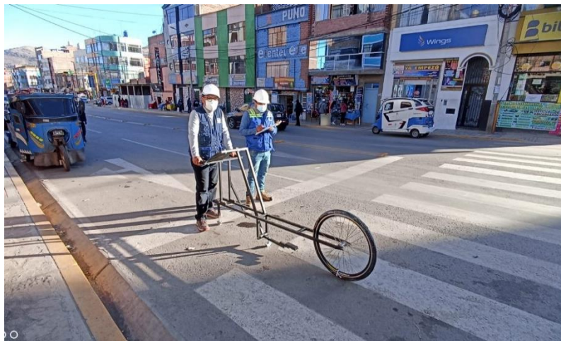
Figura 8. Operación del equipo rugosímetro de MERLÍN, tramo 1+500 Fuente: Elaboración propia
