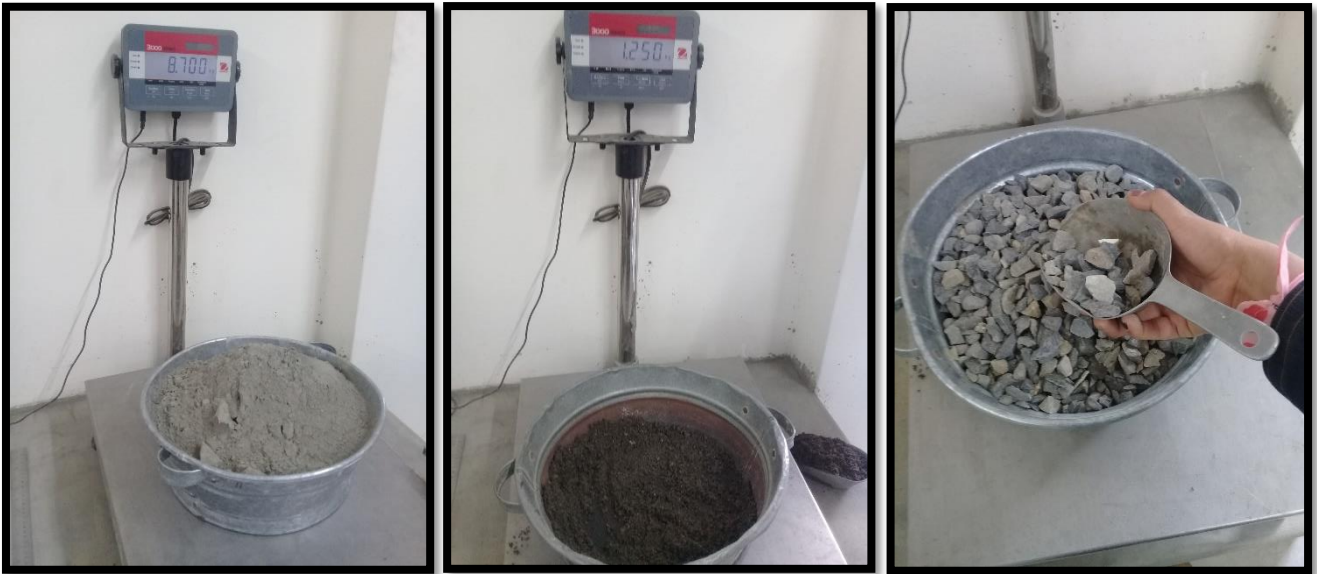
Foto N°19: Pesaje y mezclado de las materias primas.
