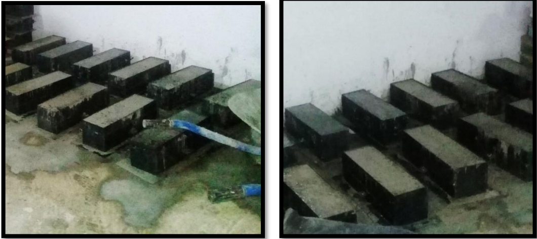
Figura 25: Matrices de Viguetas cubiertas.
