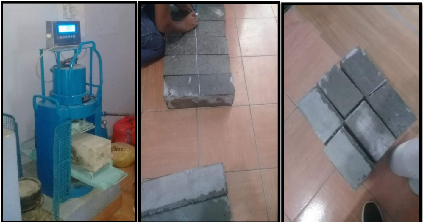
Foto N°43: Resultados de rotura de vigueta.
