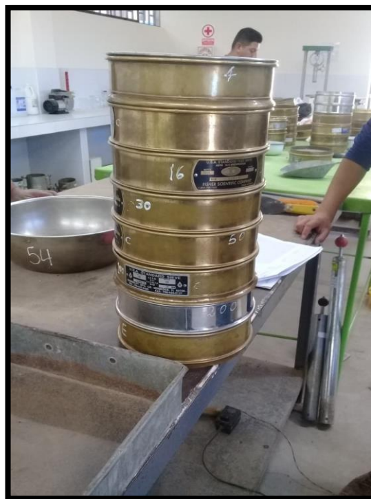
Foto N°26: Colocación de la muestra sobre los tamices.
