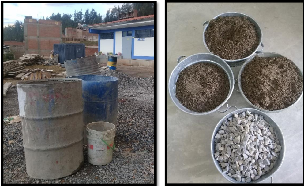
Foto N°21: Ensayo Granulométrico de los agregados.
