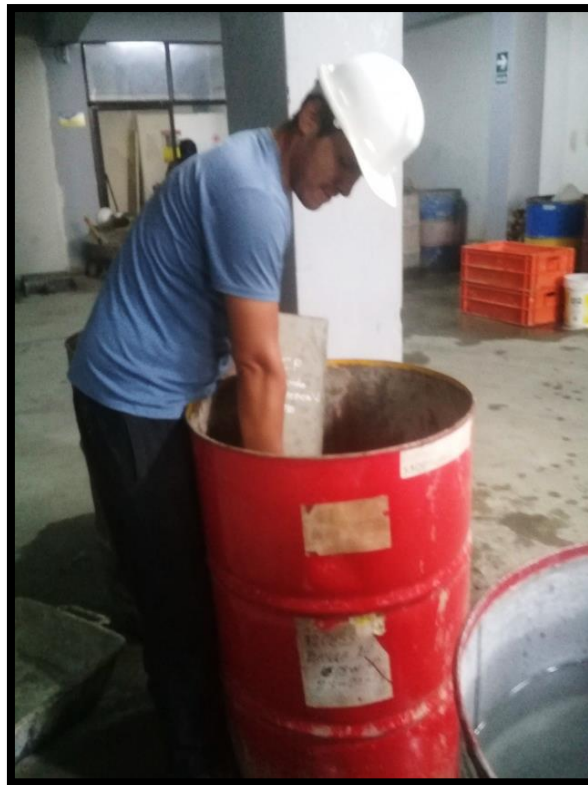
Figura 28: Cilindro para sumergir los ensayos.
