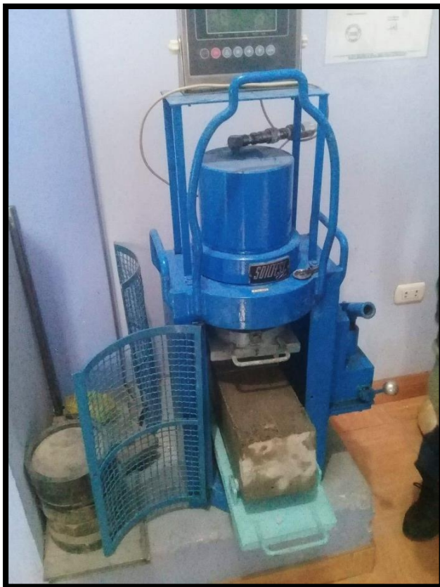
Figura 30: Proceso de la Maquina a Flexión
