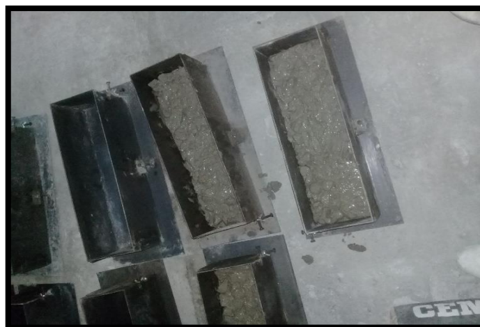
Figura 22: Primera capa de alrededor de 320g de mortero.
