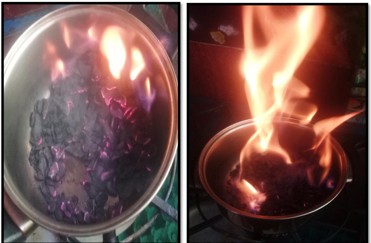
Foto N°12: Proceso de la incineración insitu de la cáscara de papa Yungay.
