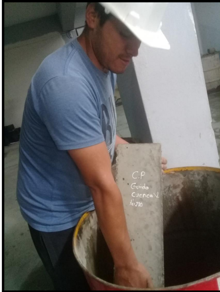
Foto N°39: Viguetas sumergidas en el cilindro con agua.
