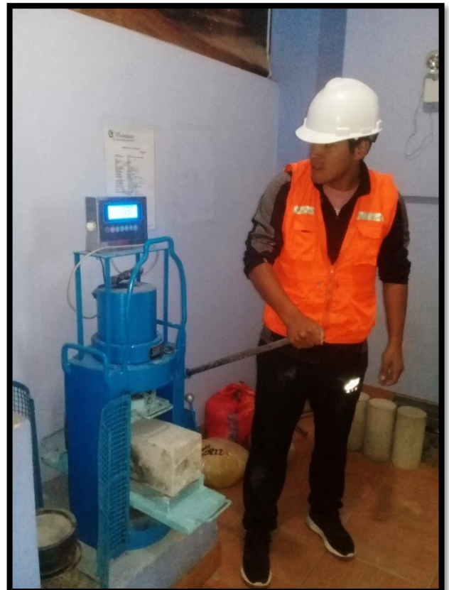
Figura 30: Proceso de la Maquina a Flexión
