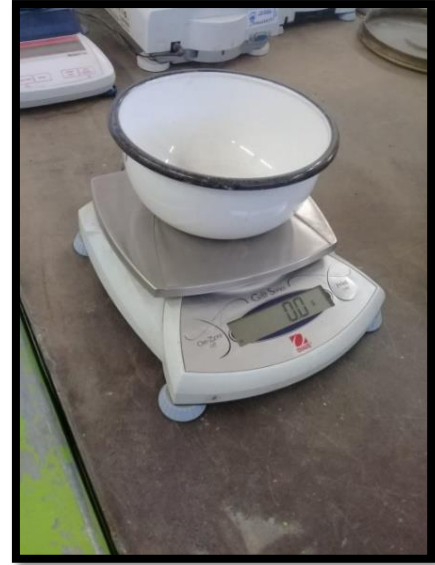
Figura 12: Balanza Electrónica Tarado en 00.g
