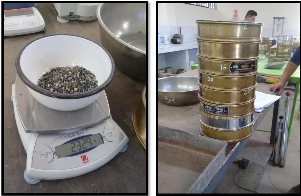
Figura 14: Peso de la Arena tamizado por la Malla N° 16
