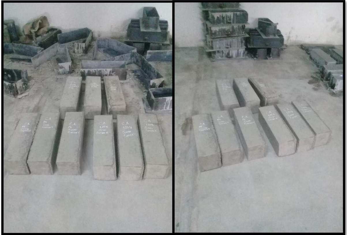
Foto N°37: Culminado de Viguetas.
