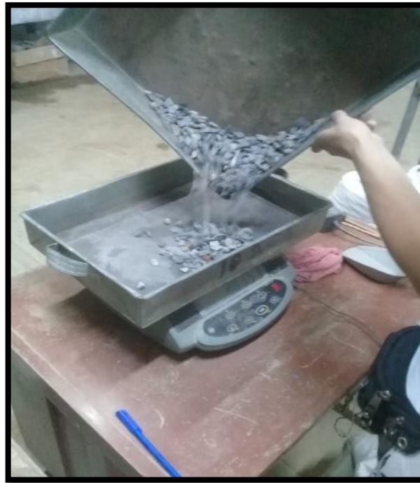
Foto N°26: Colocación de la muestra sobre los tamices.
