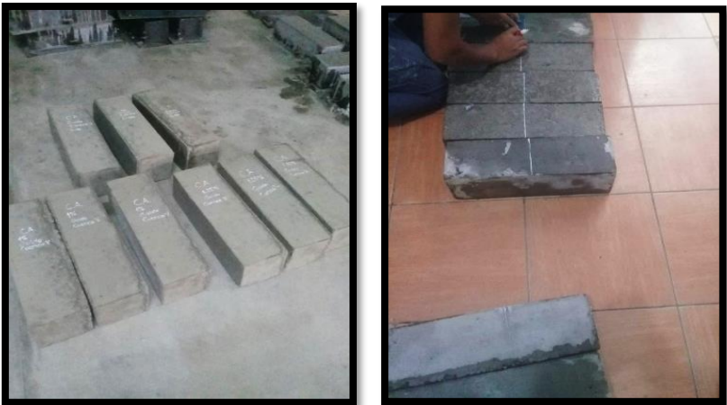
Figura 31: Viguetas Marcadas en proceso para la Ruptura.
