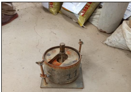
FOTOGRAFIA N° 11 ENSAYO A LA RESISTENCIA - CBR.
