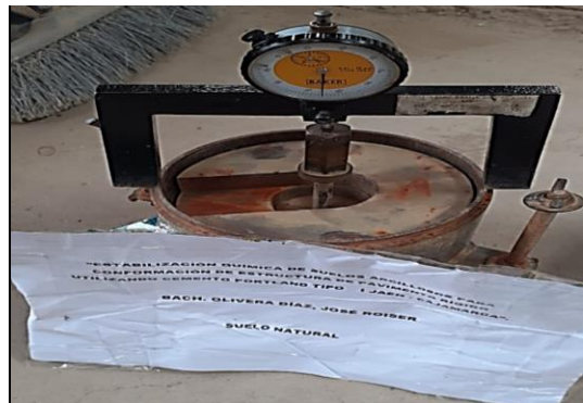
FOTOGRAFIA N° 16 MEDICION DE CBR.
