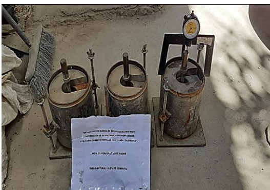
FOTOGRAFIA N° 17 MEDICION DE CBR.
