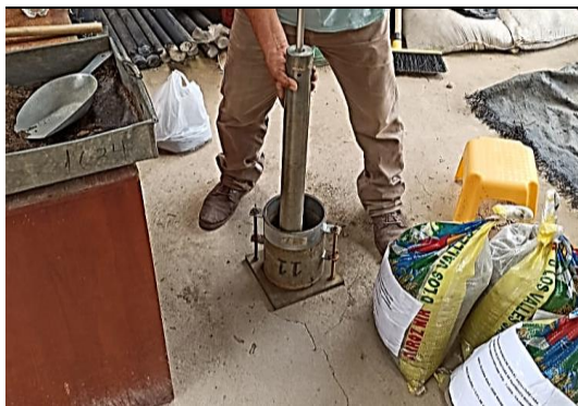
FOTOGRAFIA N° 09 ENSAYO DE COMPACTACION - PROCTOR.
