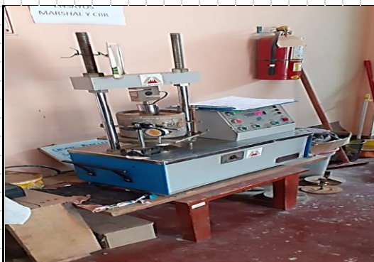
FOTOGRAFIA N° 23 ENSAYO DE PENETRACION - CBR.
