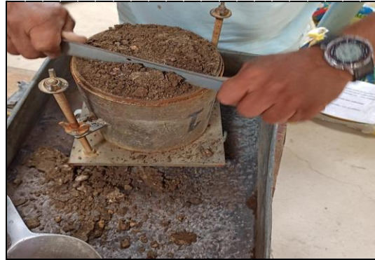
FOTOGRAFIA N° 08 ESNAYO DE COMPACTACION - PROCTOR.
