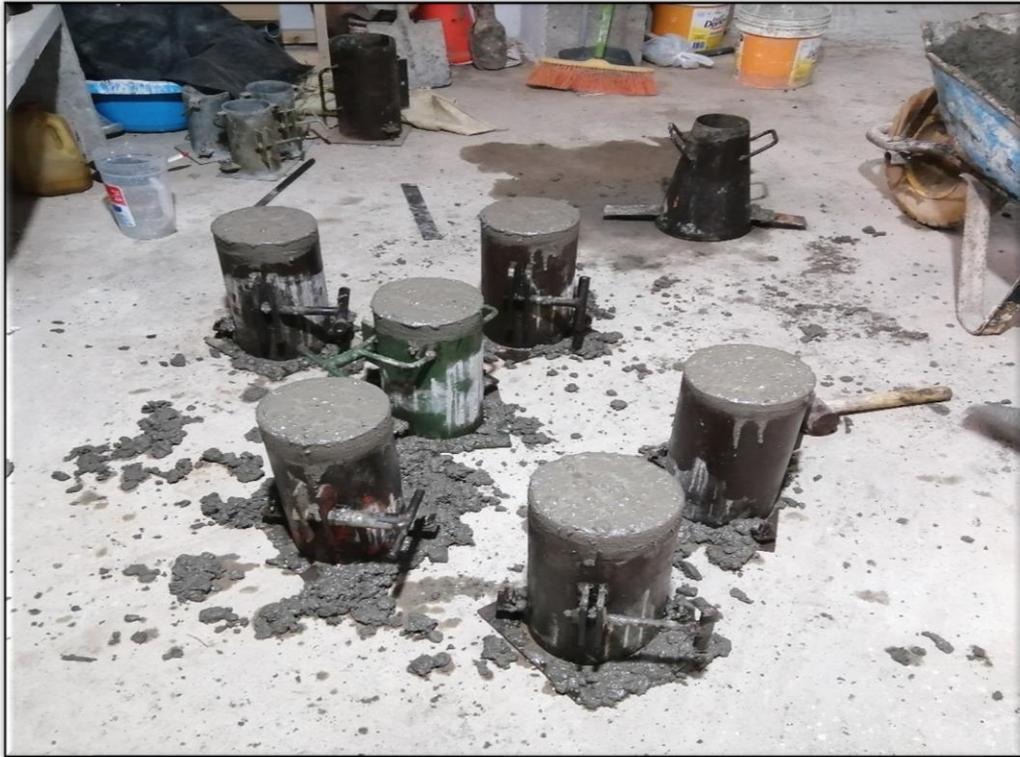
Curado de las muestras cilíndricas.
