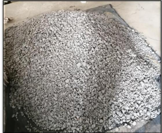
Selección de material granular para ensayo de % humedad natural.
