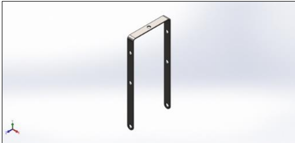
Figura 25 – Modelado del soporte de carrete. Fuente: SOLIDWORKS
