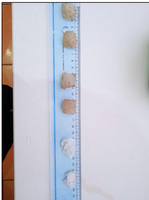
Anexo N° 4.8: Películas plastificadas después del ensayo de biodegradación
