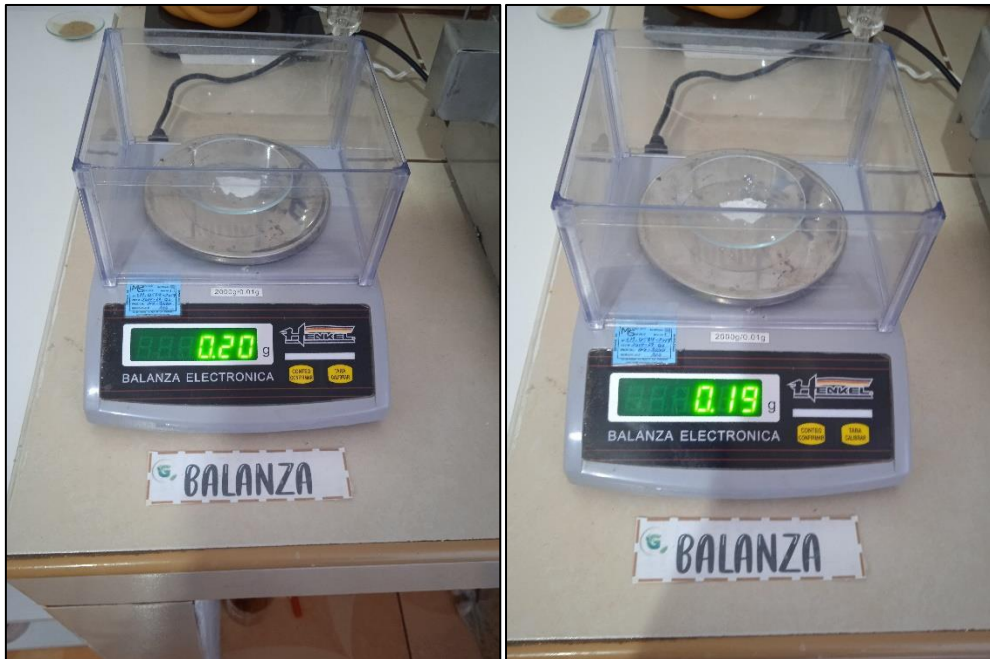
Anexo N° 4.7: Pesado de las películas plastificadas a 4 días de iniciado el ensayo de biodegradabilidad
