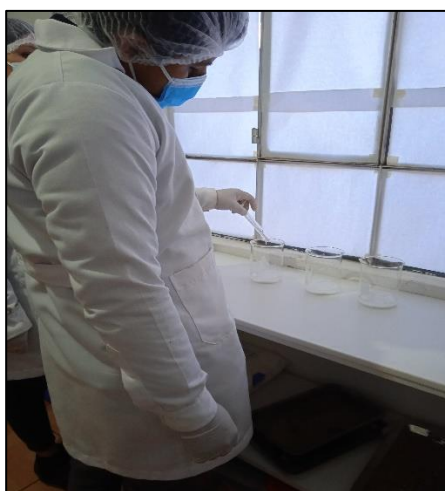
Fuente: Elaboración propia Figura 2. Mezcla de almidón, agua destilada y glicerina
