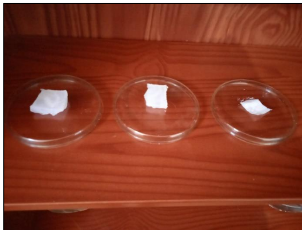
Anexo N° 4.3: Cortado de las películas plastificadas en las dimensiones de 2,5 cm x 2,5 cm
