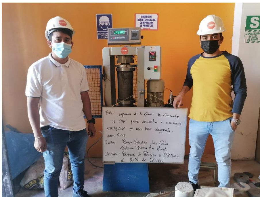
Figura N.º 4.25: Rotura de probetas del concreto con el 0.10 de adiciones por sustitución del agregado fino por la ceniza a 28 días de curado por saturación
