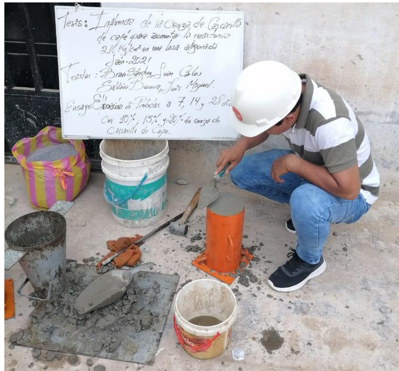
Figura N.º 4.10: Producción de probetas con el 0.0, 0.10, 0.15 y 0.20 de cenizas
