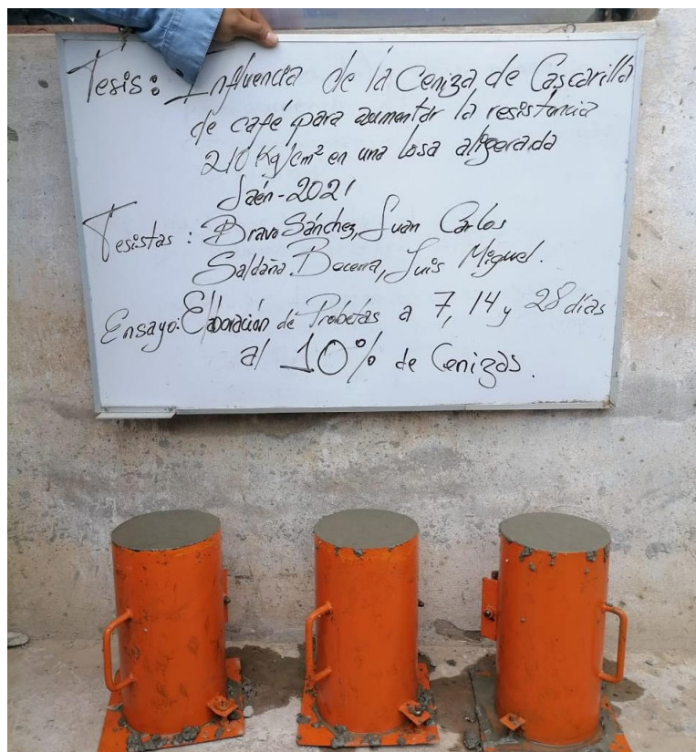
Figura N.º 4.12: Producción de probetas con el 0.10 reemplazando al agregado fino pro cenizas.
