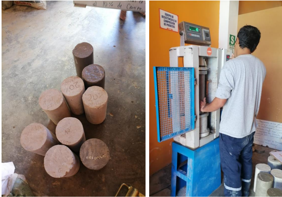
Figura N.º 4.21: Ensayo a compresión de testigos con sustituciones parciales del 0.10, 0.15 y 0.20 a 28, 14 y 07 días de curado por saturación.
