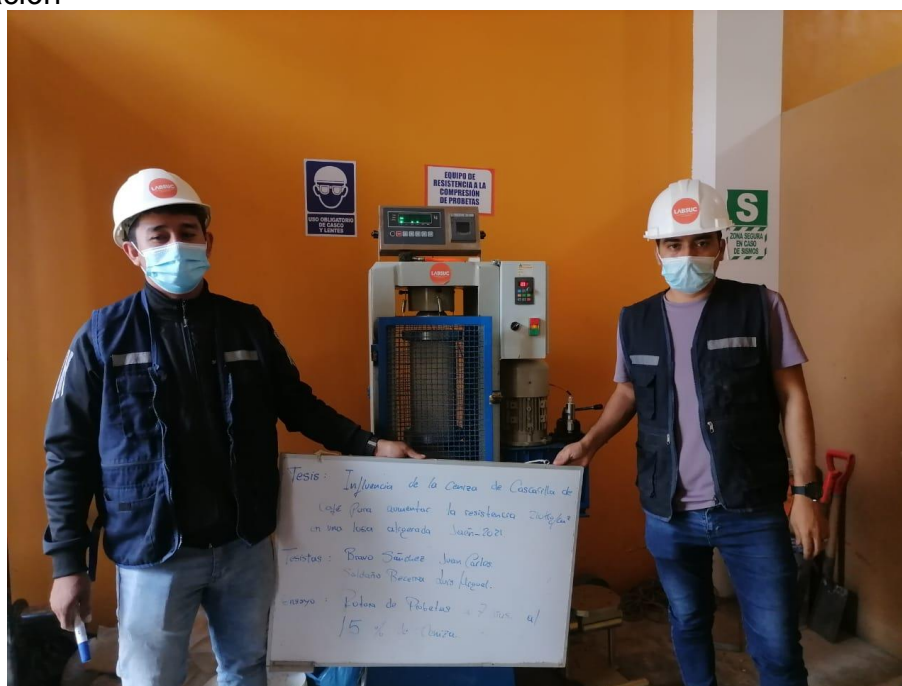
Figura N.º 4.25: Rotura de probetas del concreto con el 0.10 de adiciones por sustitución del agregado fino por la ceniza a 28 días de curado por saturación
