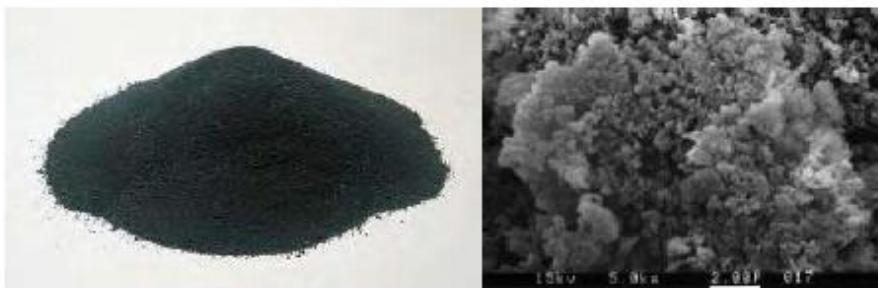
Figura 4. Micro sílice y su micrografía de partículas
