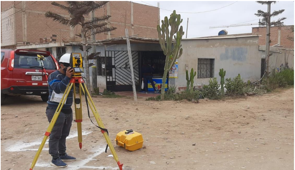
Figura 4: Radiación de puntos para obtener la forma de la superficie del terreno.
