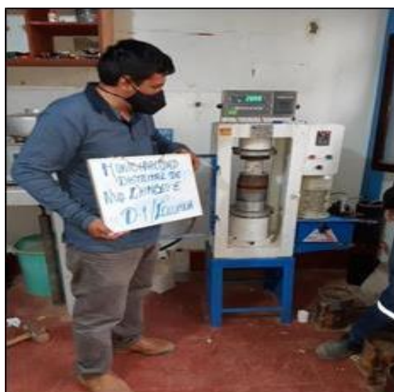
Figura 6: Estudio de la resistencia a la compresión en prensa de concreto uniaxial, D-01 columna.
