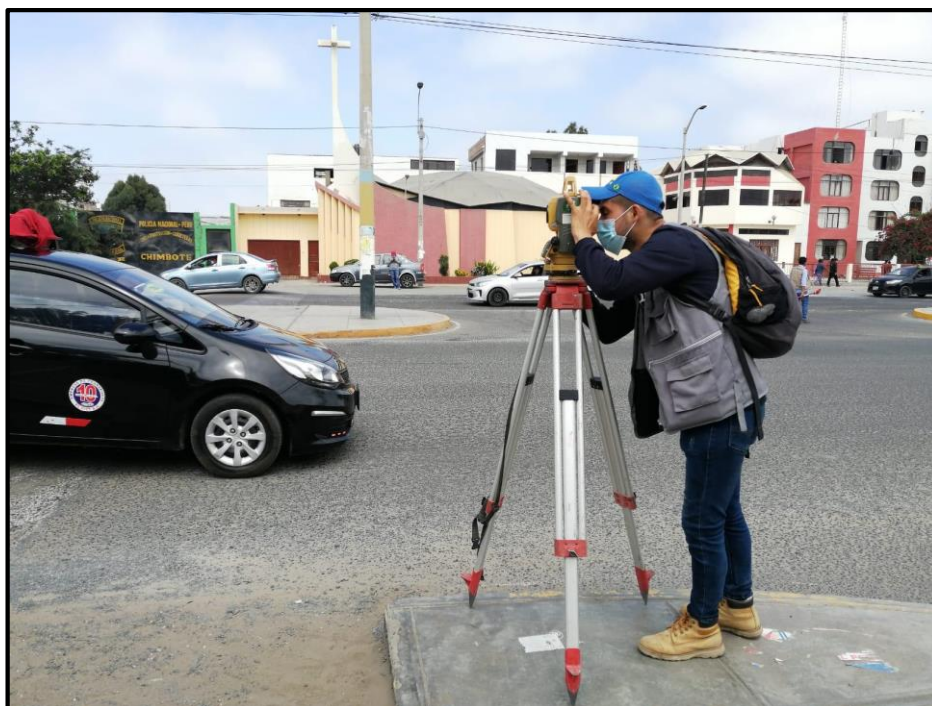
Figura 37. Se puede observar al tesista haciendo uso del equipo estación total.
