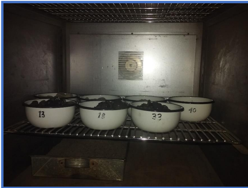
Imagen 14 y 15. Se colocó las taras en el horno para culminar el ensayo de peso y absorción del agregado grueso.
