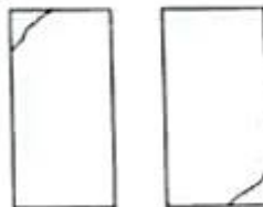
Tipo 5 Fracturas de lado en las bases (superior o inferior) ocurren comúnmente con las capas de embonado
