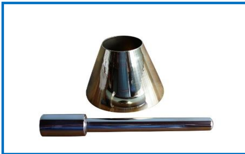
Figura 12.Cono y mazo de absorción
