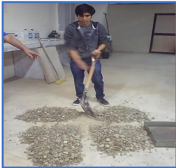
Imagen 3 y 4. Cuarteo del agregado grueso.
