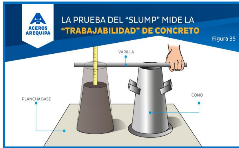
Figura 3. Prueba de Slump del Concreto
