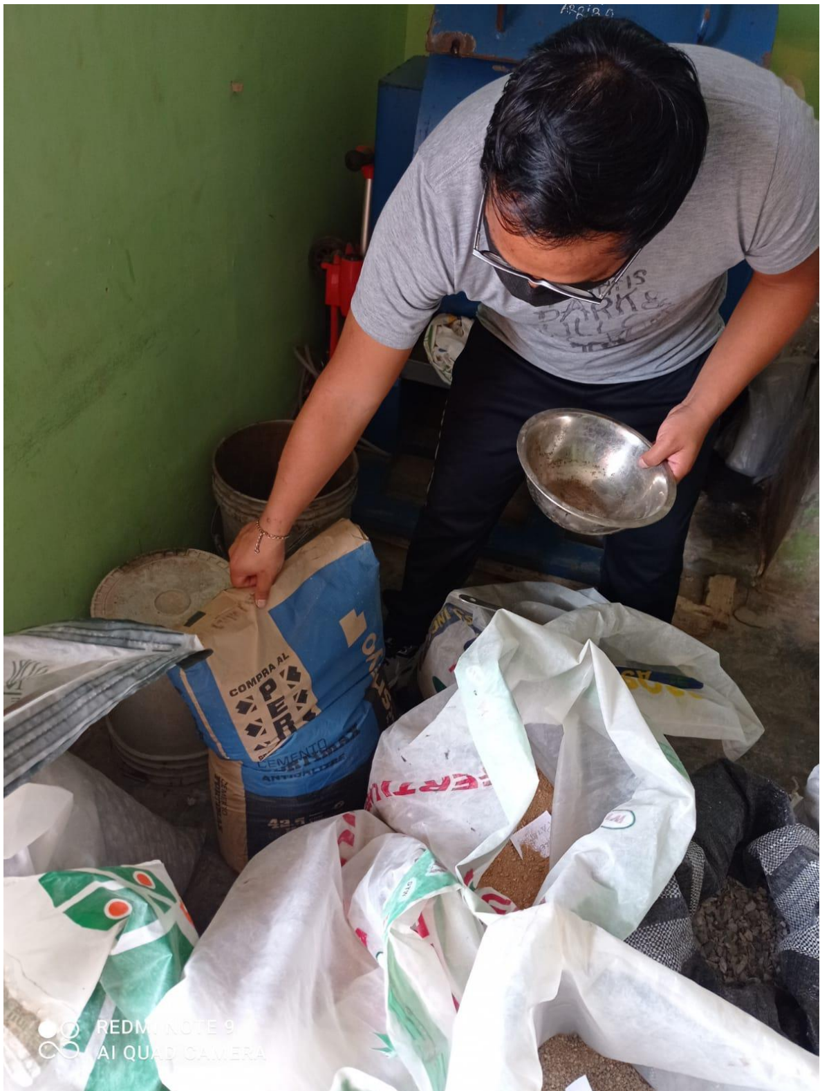
Recolección y etiquetado de muestras de agregados y viruta metálica
