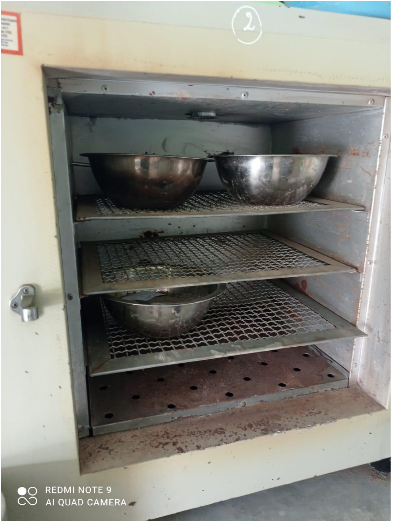
Secado al horno de los agregados
