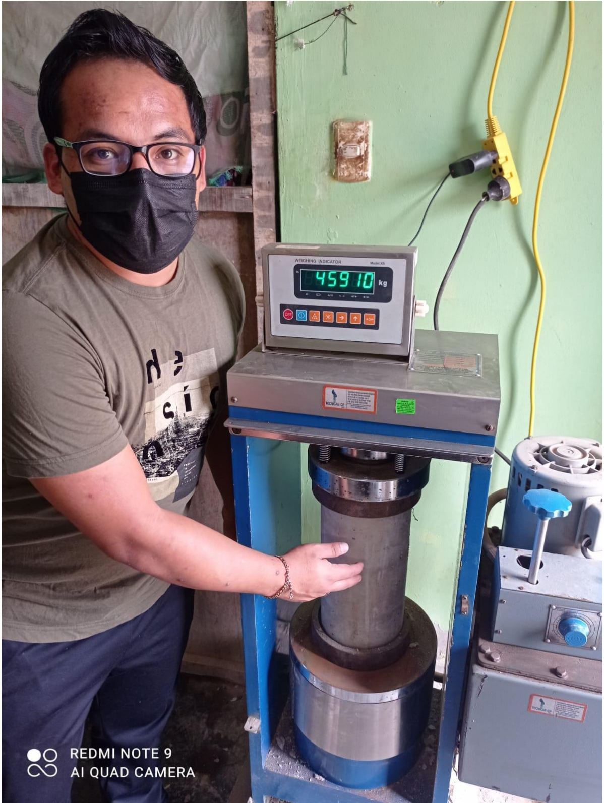
Rotura de Probetas e Identificación de Viruta en Probeta
