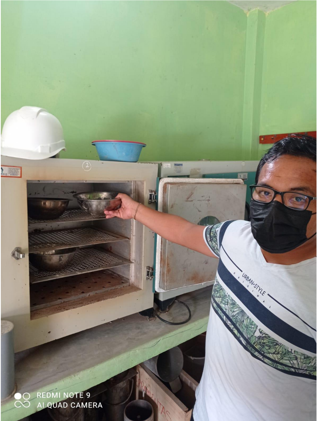
Secado al horno de los agregados
