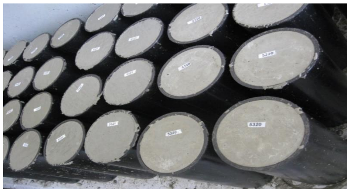
Figura 9. Se muestra los testigos para ser sometidos en la prensa hidráulica y determinar su resistencia a los 7, 14 y 28 días. (Fuente: Perú blog, 2020)
