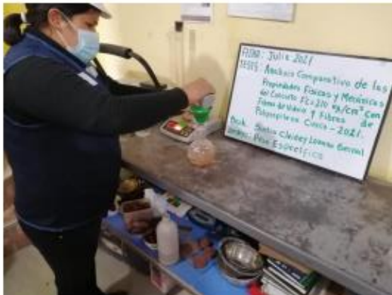
Fotografía 7 y Fotografía 8 DERECHA: Determinación del peso específico, IZQUIERDA: Pesado de las cazuelas con muestras para determinación el contenido de humedad.
