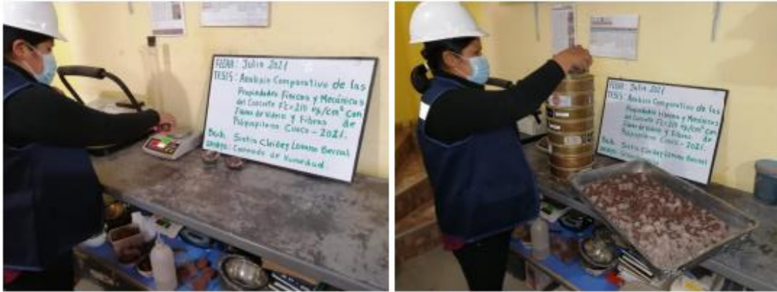
Fotografía 1 y Fotografía 2 DERECHA: Determinación del contenido de humedad, IZQUIERDA: Análisis granulométrico. (FUENTE: INGEOMAT.)
