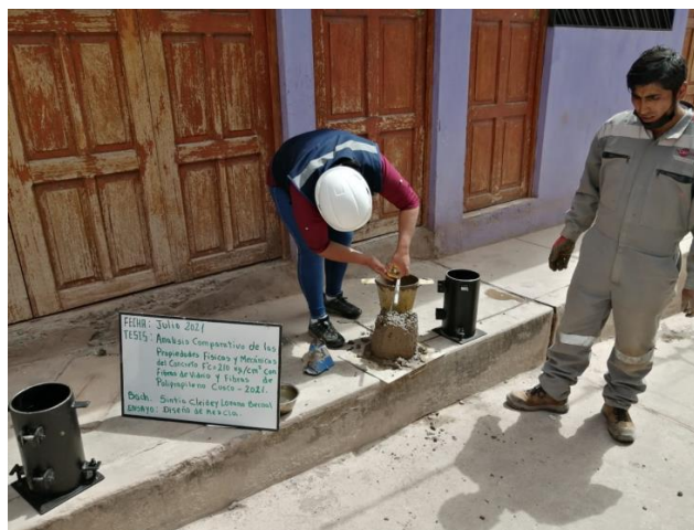
Figura N° 9: Medición del SLUMP
