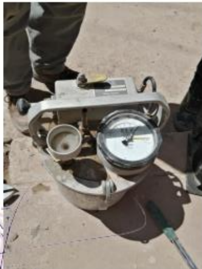
fotografía 11 Ejecutando el ensayo de contenido de aire.
