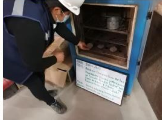
Fotografía 5 Y Fotografía 6 DERECHA: Análisis granulométrico, IZQUIERDA: Colocación de las muestras en el horno para determinar el contenido de humedad.
