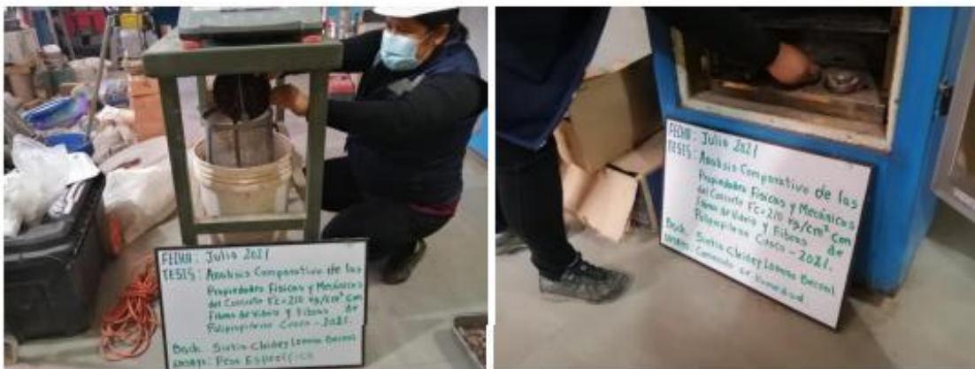
Fotografía 3 y Fotografía 4 DERECHA: Determinación del peso específico, IZQUIERDA: Colocación de las muestras al horno para determinar el contenido de humedad.
