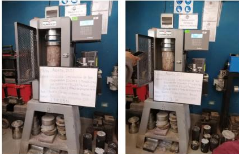
Fotografía 1 y Fotografía 2: Rotura de las briquetas de elementos CONCRETO PATRON – B Y F.V. 2% - A.
