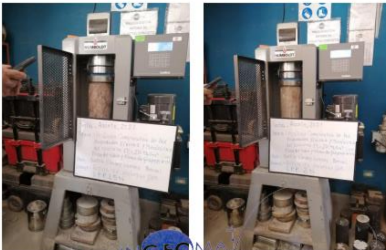
Fotografía 3 y Fotografía 4: Rotura de las briquetas de elementos F.V. 2.5% - A Y F.V. 3% - A.
