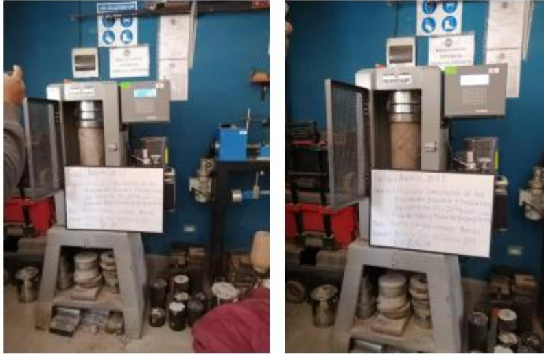
fotografía 5 y fotografía 6 Rotura de las briquetas de elementos F.P.P. 3% - C Y F.P.P. 2.5% - C.
