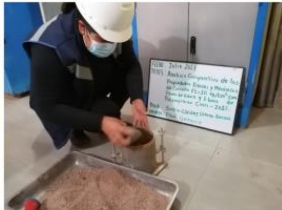
Fotografía 7 y Fotografía 8 DERECHA: Determinación del peso específico, IZQUIERDA: Pesado de las cazuelas con muestras para determinación el contenido de humedad.
