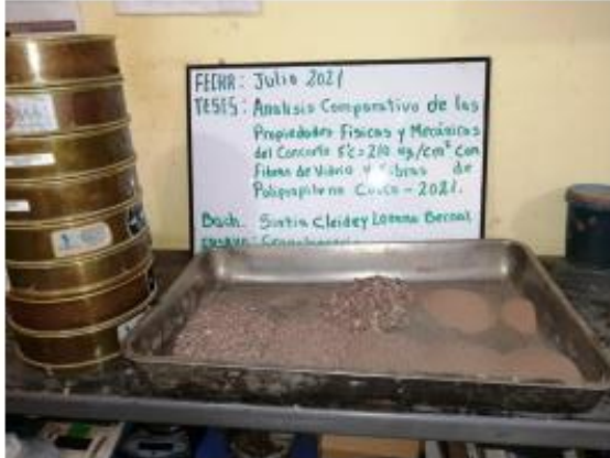
Fotografía 5 Y Fotografía 6 DERECHA: Análisis granulométrico, IZQUIERDA: Colocación de las muestras en el horno para determinar el contenido de humedad.
