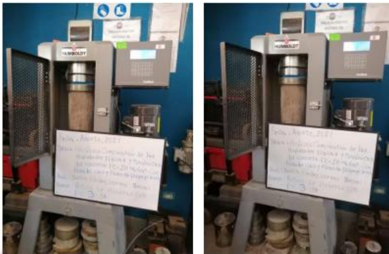
fotografía 7 y fotografía 8 Rotura de las briquetas de elementos F.P.P. 2% - B Y F.V. 3% - C.
