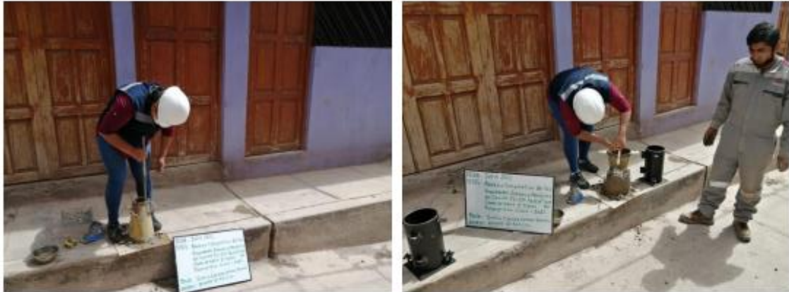
fotografía 9 Y fotografía 10 DERECHA: Varillando el concreto en el cono de abrams , IZQUIERDA: Midiendo cuanto de slump tiene el concreto. (FUENTE: INGEOMAT.)
