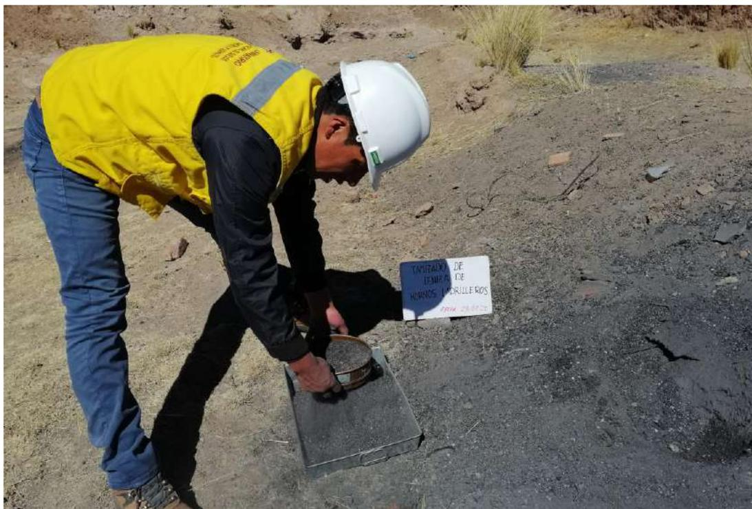
**FOTO N° 5:** Proceso de tamizado de cenizas
