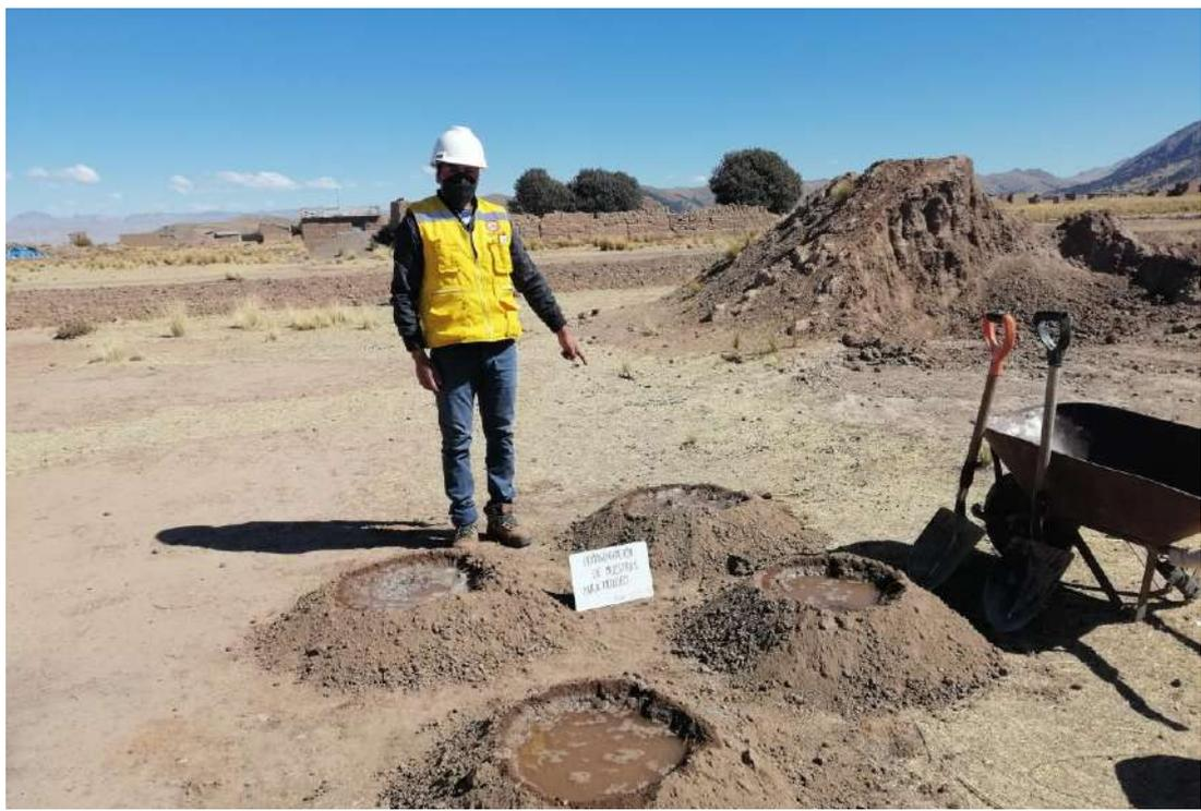
**FOTO N° 3:** Proceso de homogenización de muestras
