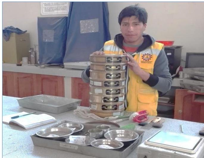
*Figura 18:* Proceso de tamizado de muestra de suelo de la cantera seleccionada
