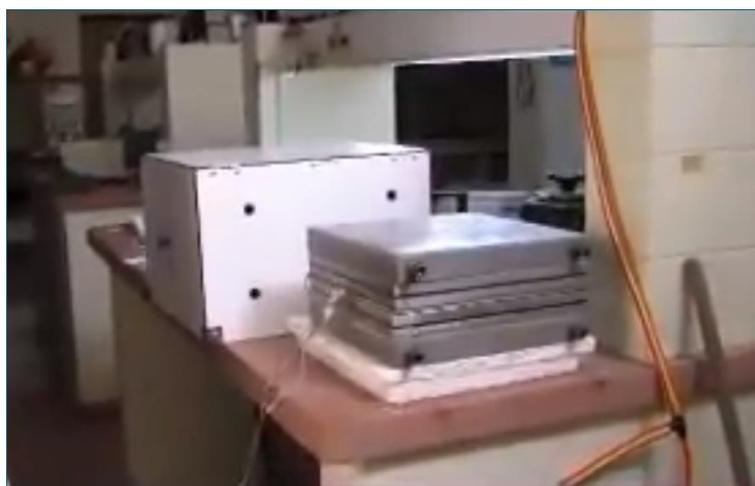
Figura 21: Equipo de placa para ensayo de conductividad térmica
