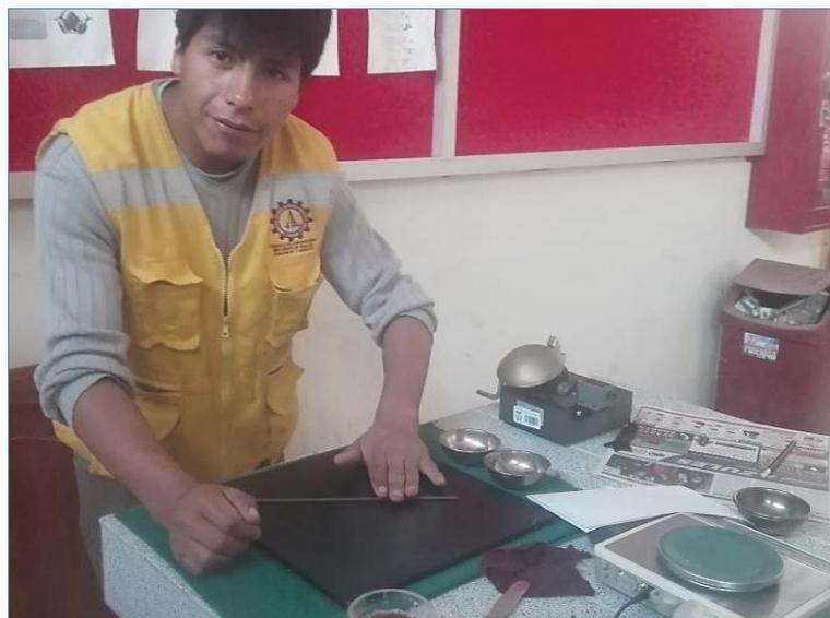
Figura 20: Ensayo de Límite Líquido y Límite Plástico.
