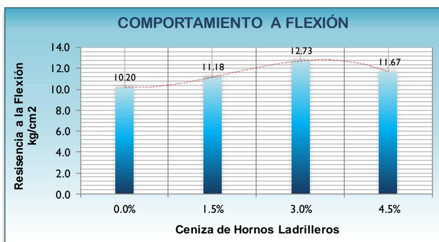
Figura 28: Resultados del ensayo de resistencia a flexión
