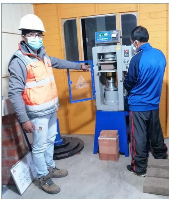
Figura 23: Ensayo de resistencia a la compresión.
