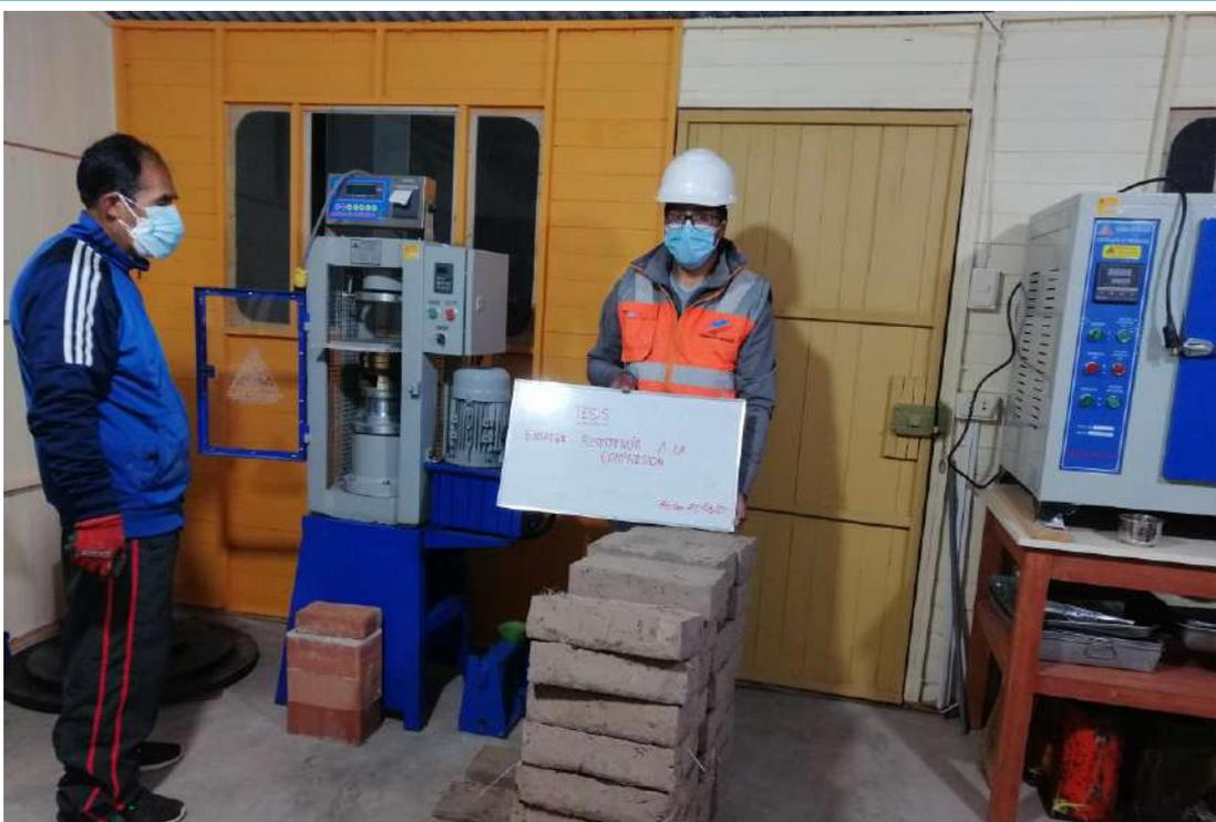
**FOTO N° 12: Ensayo de Resistencia a compresión**
