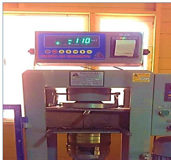
*Figura 27:* Muestra del adobe con la falla a flexión
