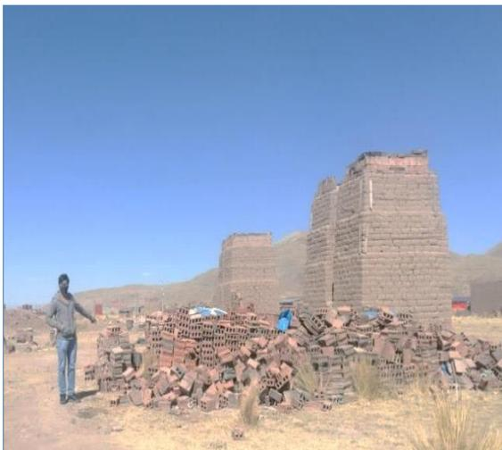
*Figura 14: Hornos para elaboración de ladrillos artesanales.*
