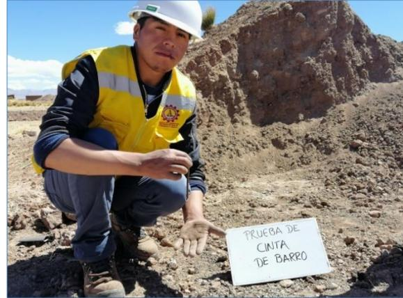
*Figura 17:* Prueba de cinta de barro para verificar presencia de arcilla
