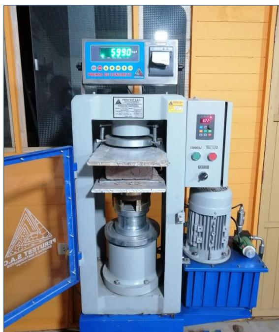
Figura 24: Muestra del adobe con la resistencia alcanzada a compresión.
