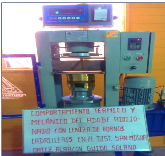
*Figura 26:* Ensayo de resistencia a la flexión
