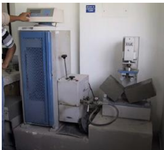
Figura 4: Ensayo de Resistencia por Flexión
