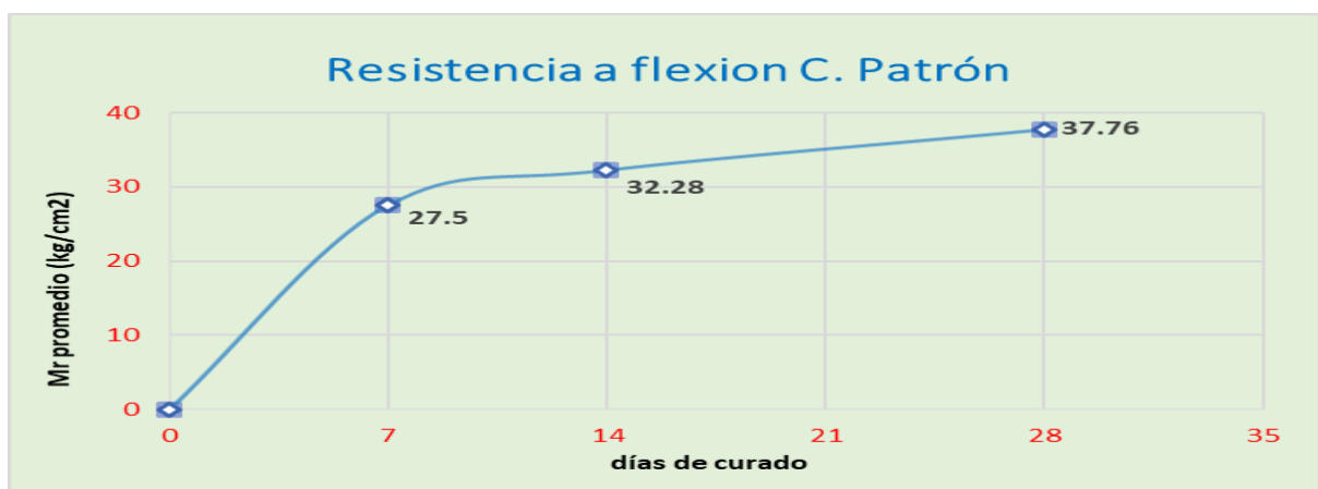
Figura 21: Curva resistencia vs Tiempo - Flexión _ Patrón
