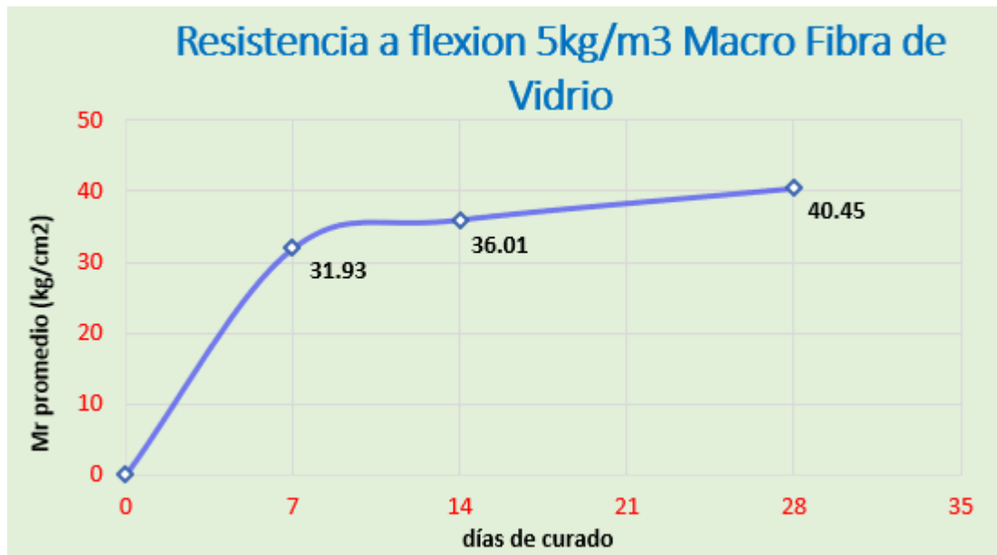
Figura 23: Curva resistencia vs Tiempo - Flexión 5kg/m3 Macro fibra de vidrio
