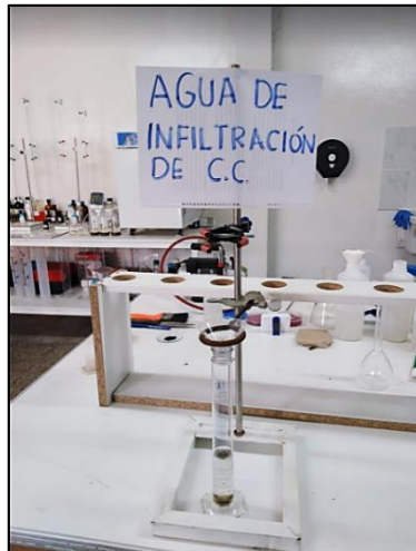
Imagen 11: medición de capacidad de campo
