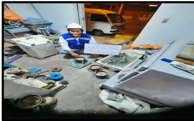
Colación de los moldes de CBR en el agua.
