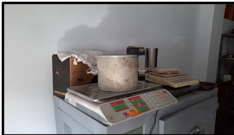
Realizando el pesado del molde de Proctor.
