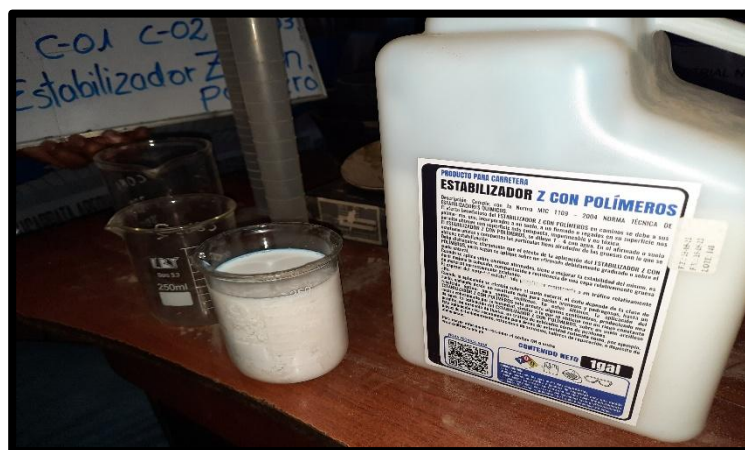
Preparación de la mezcla de agua con aditivo z.
