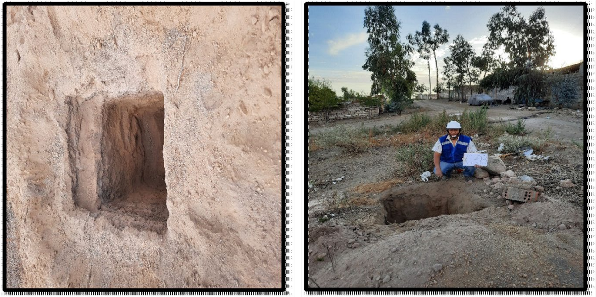
Figura 9. Calicata 0.3 excavación a una profundidad de 1.50m.
