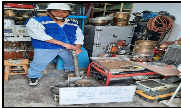
Compactación de las muestras en el Proctor.
