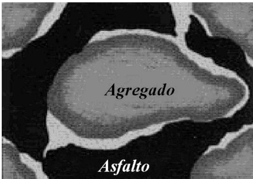
Figura N° 12: Desprendimiento del Ligante del Agregado por Efecto de la Humedad. Fuente: Deformación Permanente en Mezclas Asfálticas, 2011
