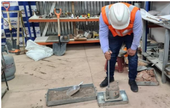
Foto 10: Peso unitario suelto y compactado agregado fino
