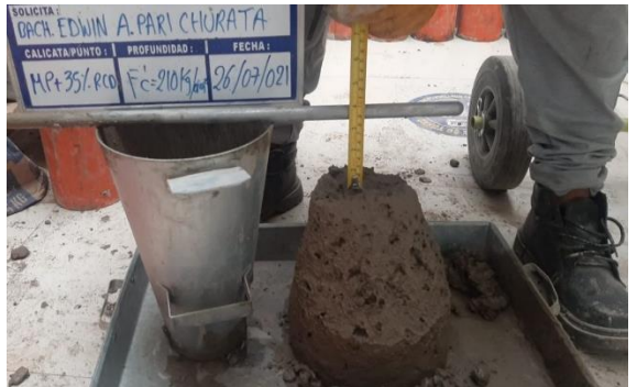
Foto 14: Slump del concreto con adición de 35%AGR
