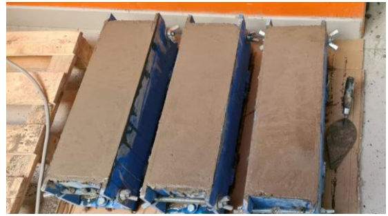
Foto 16: Moldeo de vigas
