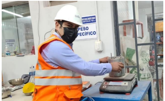
Foto 11: Peso unitario suelto y compactado agregado Grueso
