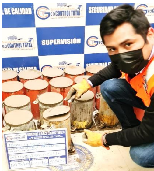
Figura N° 14: Moldeo de briquetas.
