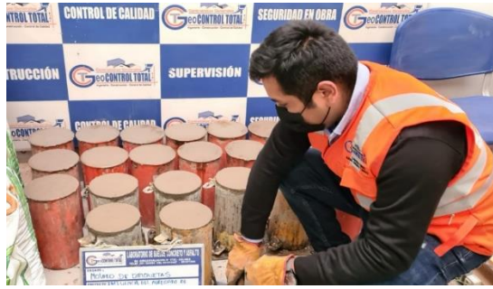
Foto 15: Moldeo de briquetas para ensayo a compresión
