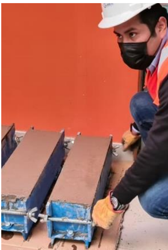
Figura N° 17: Moldeo de briquetas.
