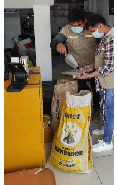
Muestreando el material para ensayo granulométrico
