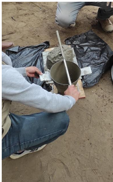
Medición de asentamiento del concreto (slump)
