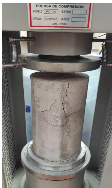
Falla de probeta con adición de lana
