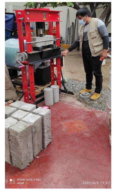
Ensayo de flexión de probetas a flexión
