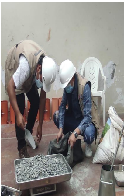
Pesado de agregados para elaboración de probetas
