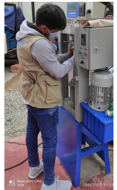
Ruptura de probetas a compresión
