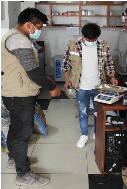
Pesado de agregado fino para ensayo de granulométrico
