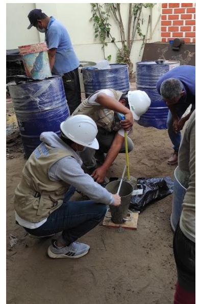
Medición de asentamiento del concreto (slump)
