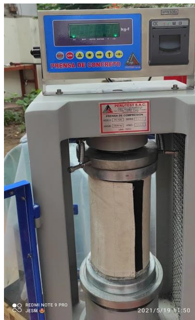
colocación de faja para ruptura de probetas
