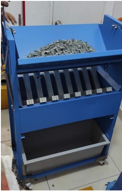
Cuarteo de agregado fino para análisis por tamizado
