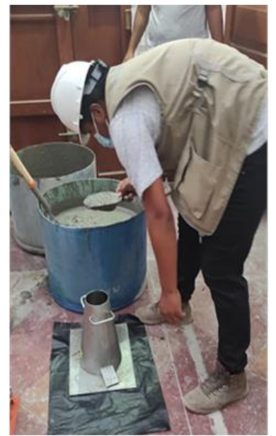
Realizando el ensayo de asentamiento del concreto
