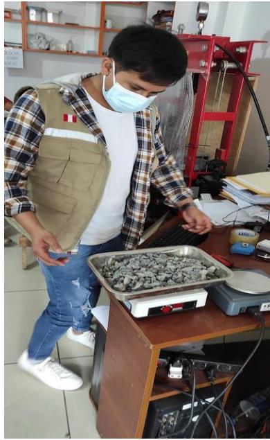
Pesado de agregado grueso para análisis por tamizado
