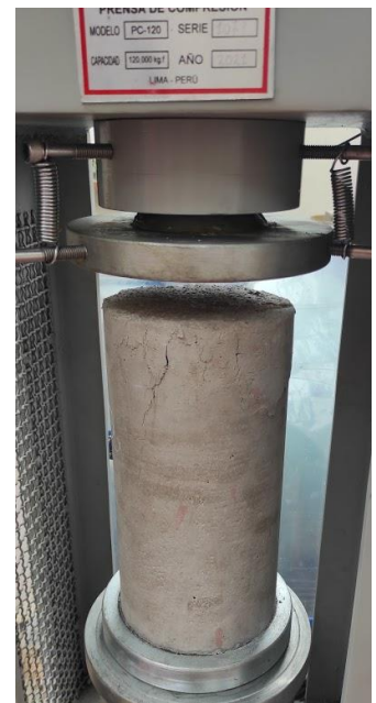
Falla de probeta con adición de fibra de polipropileno
