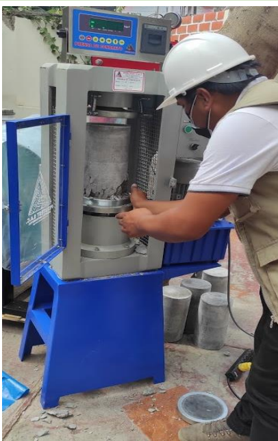
Falla por de probeta por compresión
