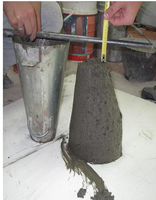
Fotografía 16. En esta foto se observa la prueba del asentamiento (SLUMP) del concreto fresco.
