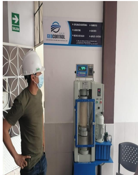
Fotografía 25. En esta foto se observa la probeta siendo ensayada a la resistencia a la compresión.
