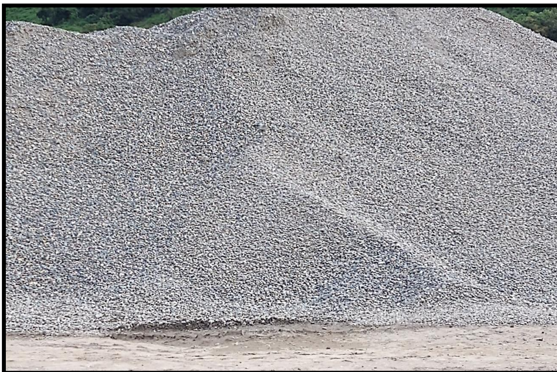
Fotografía 6. En esta foto se observa el acopio de agregado grueso en la cantera.
