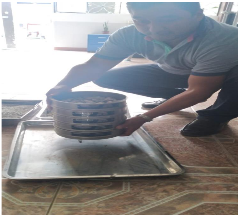
Fotografía 12. En esta foto se observa realizando el respectivo procedimiento para el ensayo de granulometría de los agregados.
