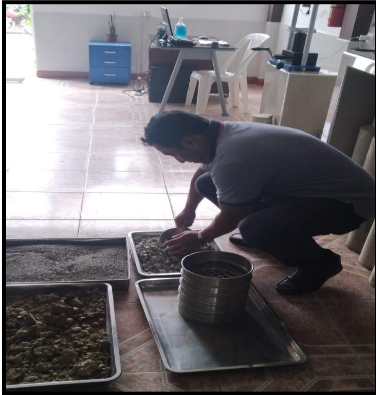
Fotografía 11. En esta foto se observa realizando el respectivo procedimiento para el ensayo de granulometría de los agregados.
