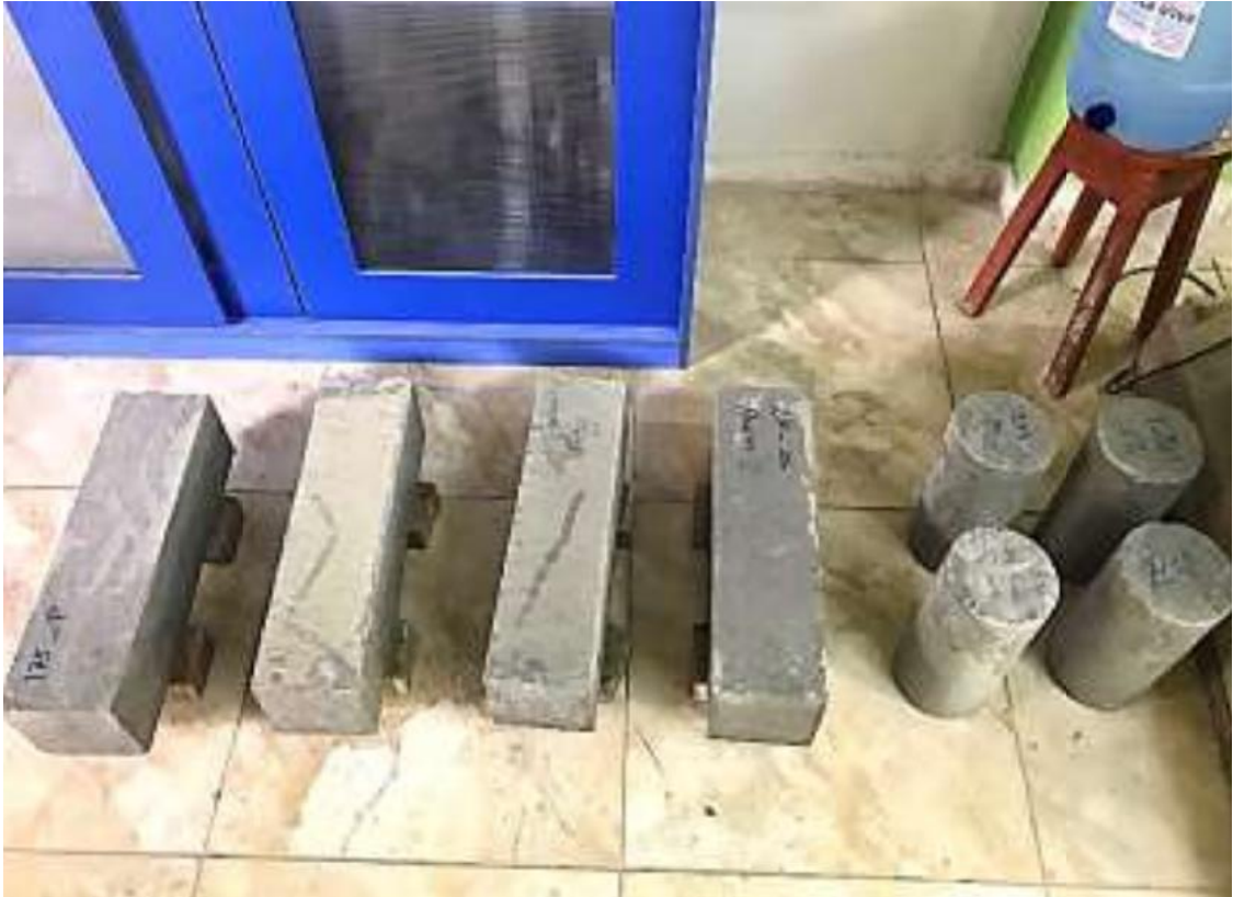
Fotografía 30. Secado de los especímenes prismáticos y cilíndricos antes de ser sometidos a sus respectivos ensayos para determinar su resistencia.
