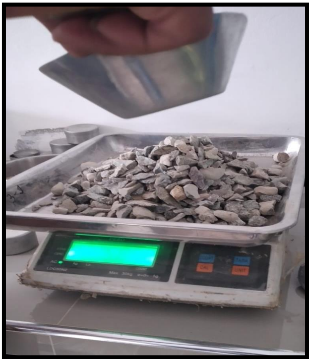
Fotografía 10. En esta foto se observa realizando el pesado de los agregados para el ensayo de granulometría.
