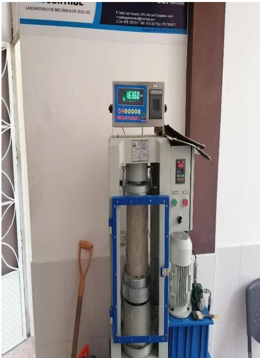
Fotografía 24. En esta foto se observa la probeta siendo ensayada a la resistencia a la compresión.
