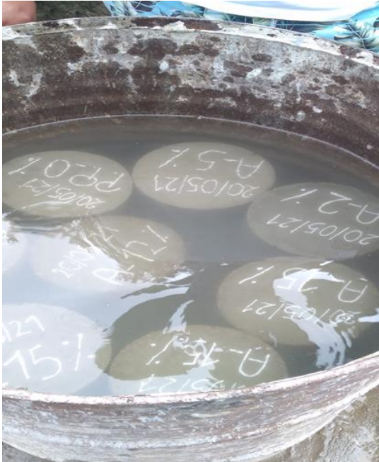
Fotografía 21. En esta foto se observa algunas de las probetas sumergidos en agua para su respectivo curado.
