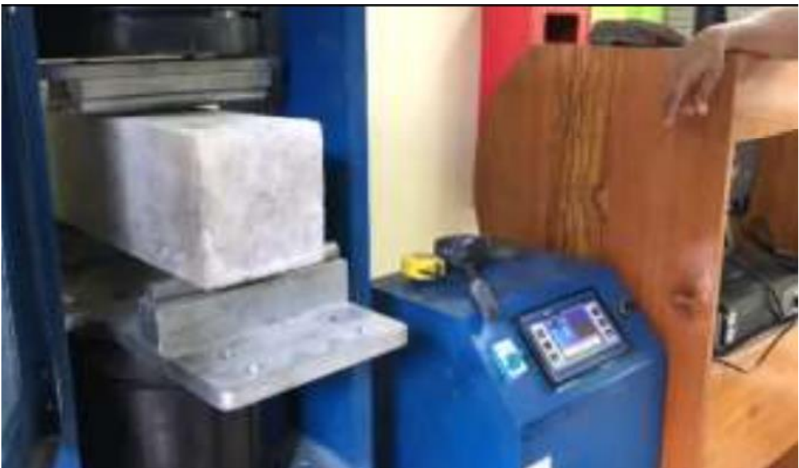
Fotografía 31. Rotura de testigo prismático para calcular el módulo de rotura y obtener su resistencia mayor.
