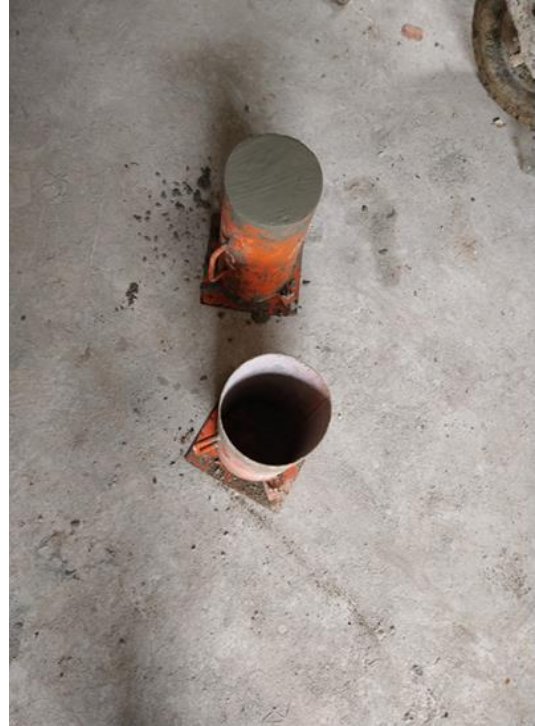
Fotografía 18. En esta foto se observa la preparación de probetas cilíndricas con los porcentajes de adición de aserrín y CCA.
