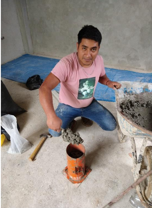
Fotografía 17. En esta foto se observa el llenado de los moldes para la fabricación de probetas.
