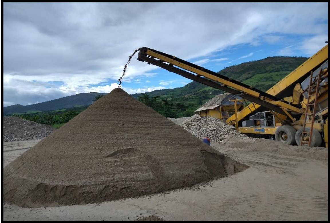
Fotografía 7. En esta foto se observa el acopio de agregado fino en la cantera.
