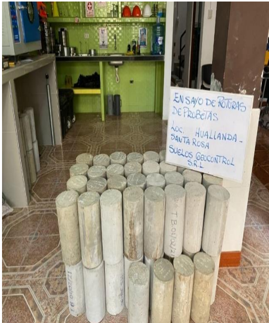
Fotografía 23. En esta foto se observa algunas de las probetas en el laboratorio para ser ensayadas a la resistencia a la compresión.
