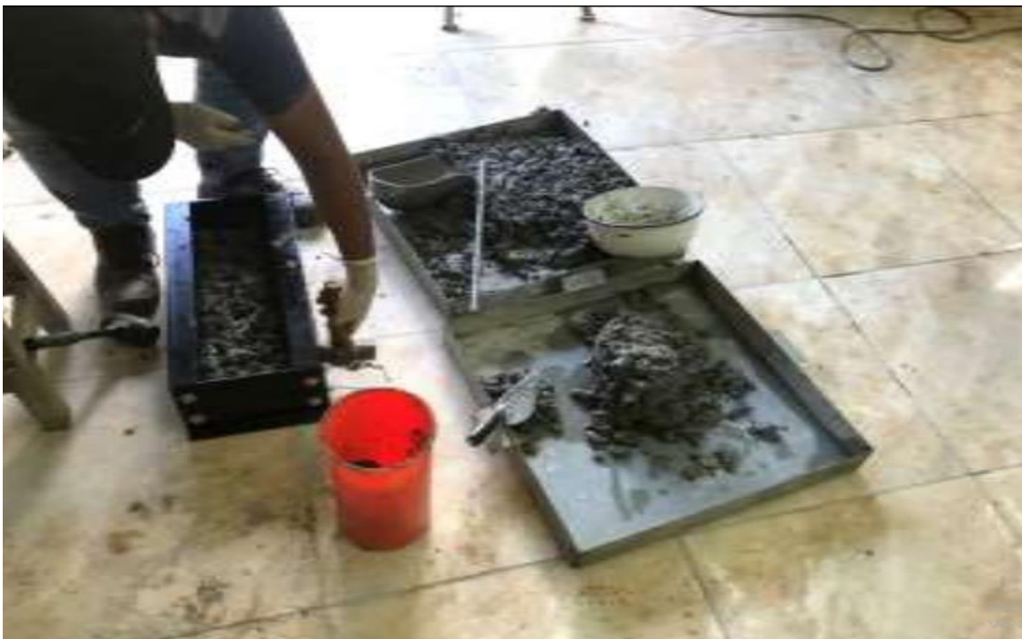
Fotografía 29. Fabricación de especímenes prismáticos de 6" x 6" por 45cm para ensayo de resistencia a la flexión.
