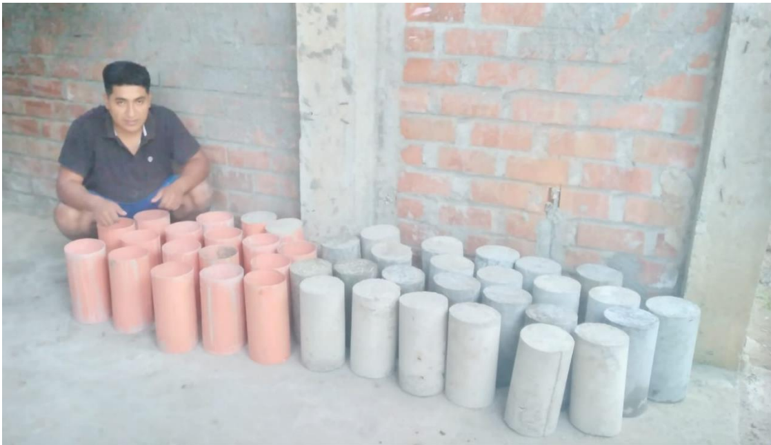
Fotografía 19. En esta foto se observa algunas de las probetas realizadas y los moldes listos para ser llenados.
