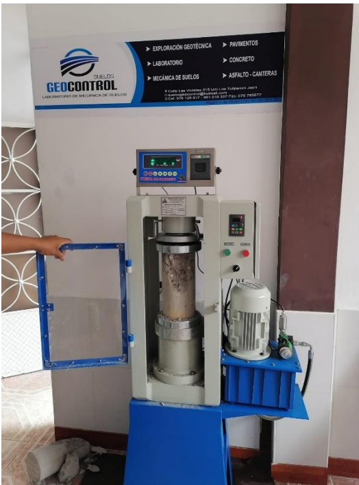
Fotografía 26. En esta foto se observa la rotura de la probeta al ser ensayada a la resistencia a la compresión.
