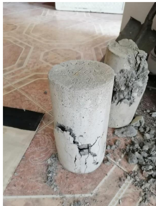
Fotografía 27. En esta foto se observa la rotura de la probeta al ser ensayada a la resistencia a la compresión.
