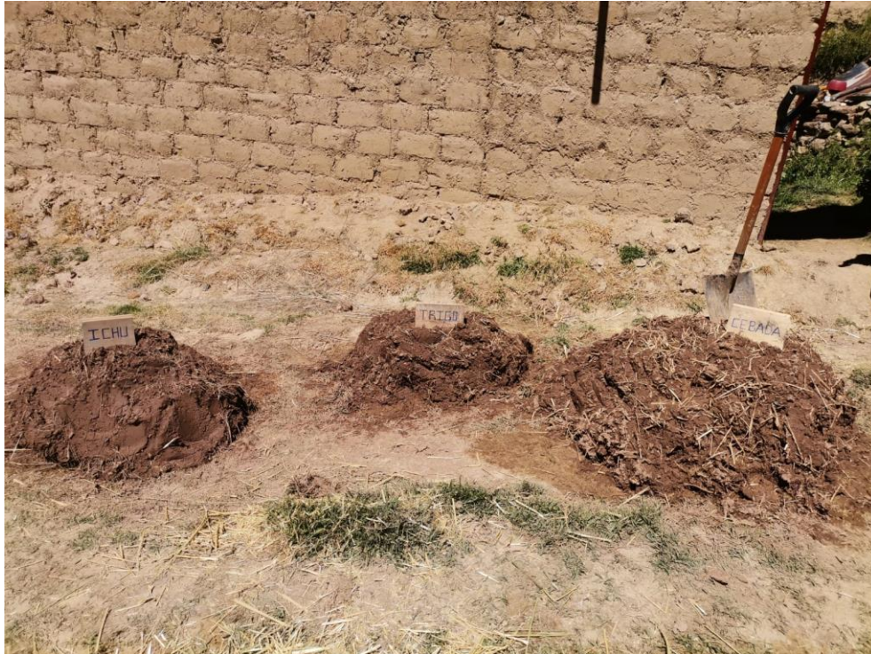
Fotografía 9. Barro preparado con las distintas pajas. Fuente: Elaboración propia
