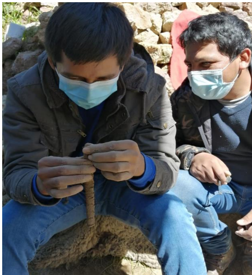
Fotografía 4. Prueba de cinta de barro. Fuente: Elaboración propia
