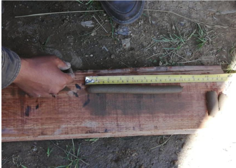
Fotografía 3. Cilindro de barro para prueba de cinta. Fuente: Elaboración propia
