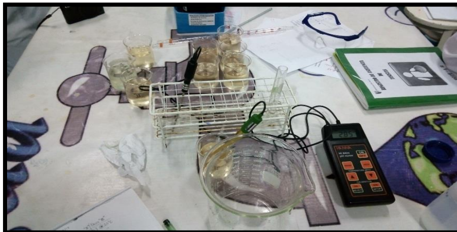
Conductímetro y pH-metro en plena medición de los parámetros correspondientes.
