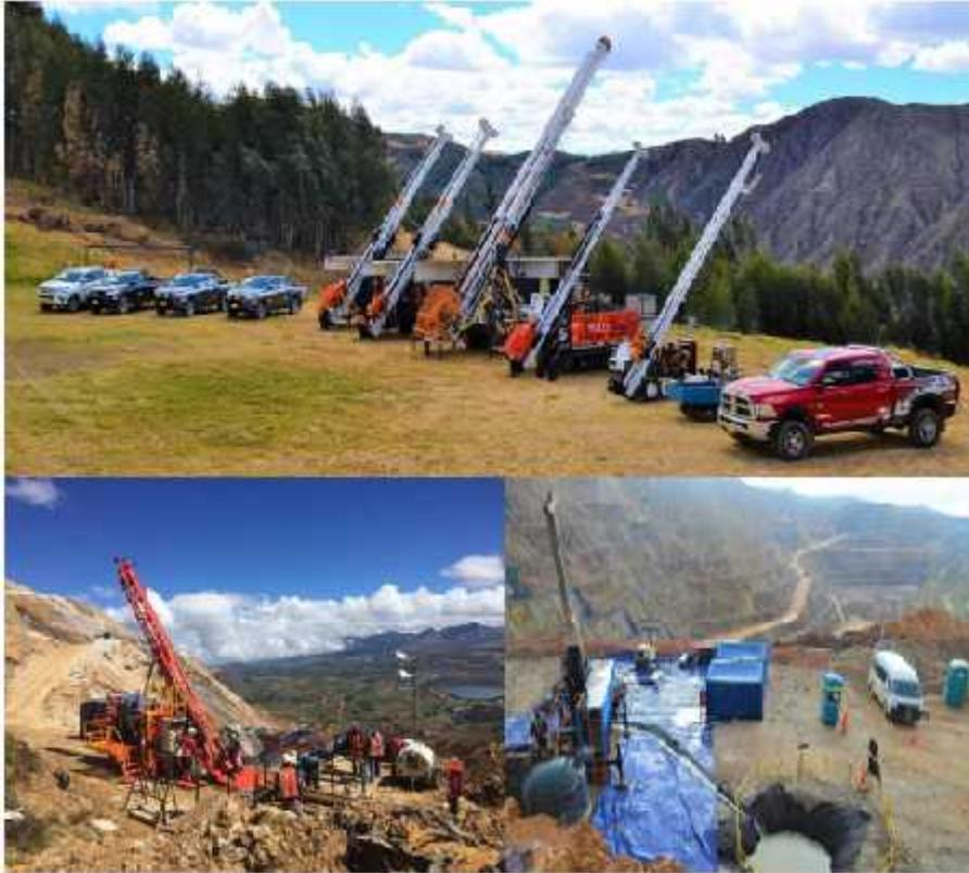
**Figura 3:** Fotografías de Perforadoras Diamantina LF90
