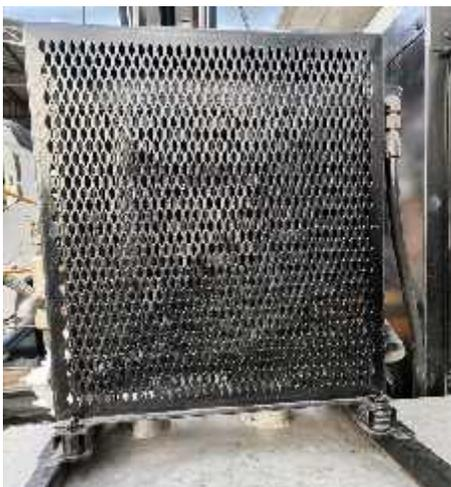
**Figura 30:** Radiador de Aceite Hidráulico
