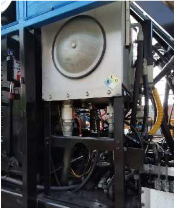
**Figura 31:** Tanque de Aceite hidráulico
