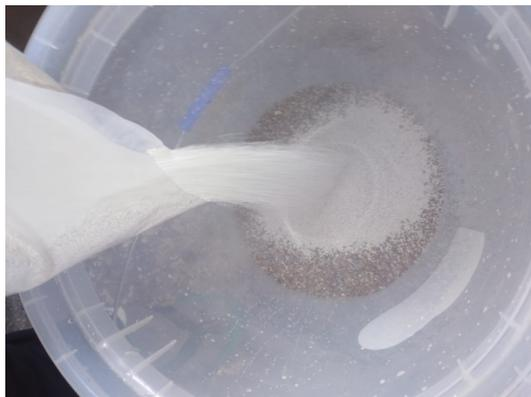
Figura N° 27: Zeolita como núcleo de biofiltros
