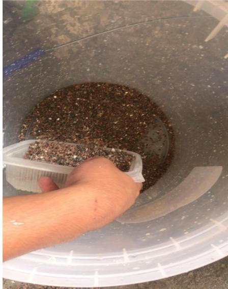
Figura N° 26: Grava como soporte de biofiltros
