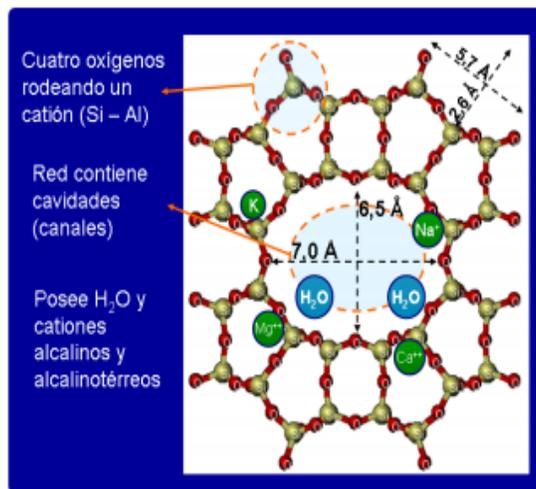
*Figura N° 1: Esquema de la molécula de la Mordenita*
