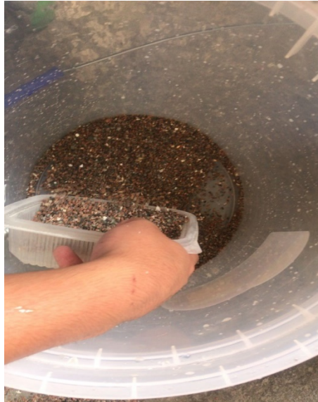
Figura N° 26: Grava como soporte de biofiltros
