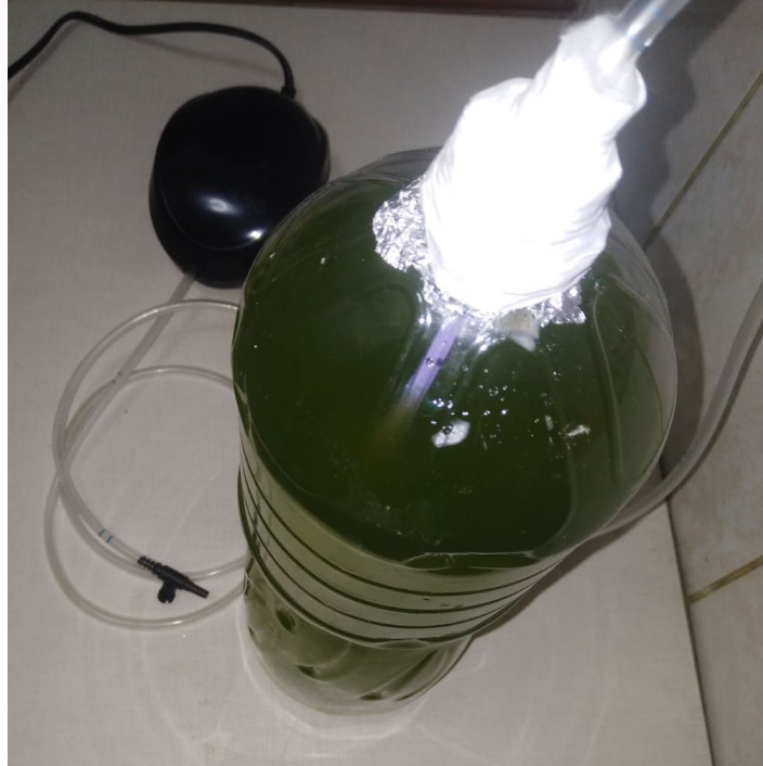
Figura N° 18: Sistema de aireación conectado con contenedor para el cultivo de la microalga Chlorella Vulgaris
