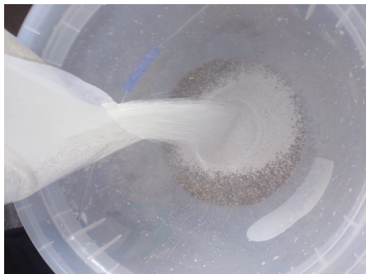
Figura N° 27: Zeolita como núcleo de biofiltros
