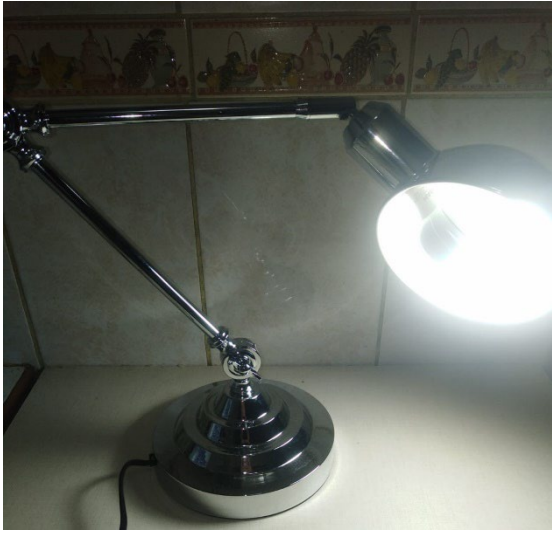
Figura N° 9: Lámpara con foco de 1650 lumens iluminación del medio de cultivo
