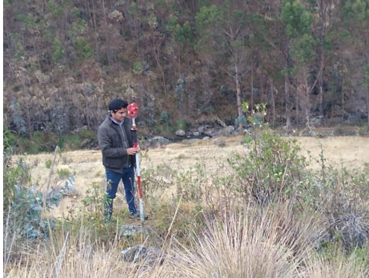
Foto 3. Agarrando el prisma a 1200 m del punto de captación
