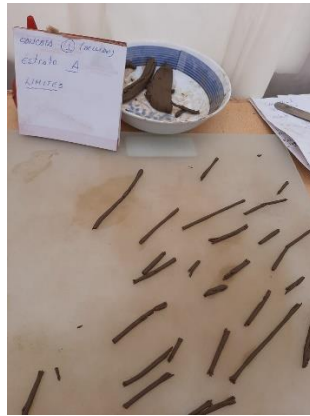
Figura 22. Ensayos de límites de Atterberg
