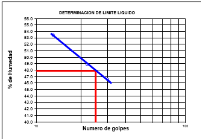
Figura 30. Determinación de límite líquido
