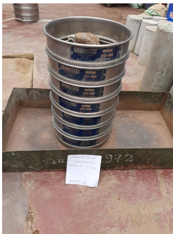
Figura 21. Tamizado de muestras
