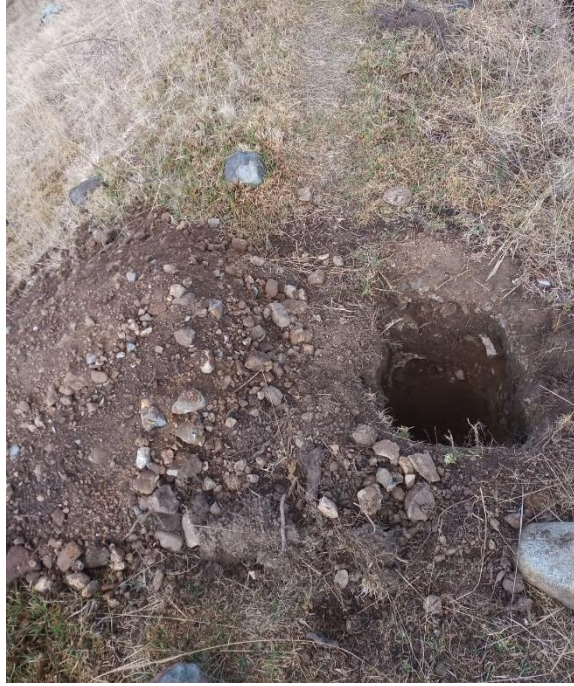
Foto 7. Tomando muestra en calicata 7
