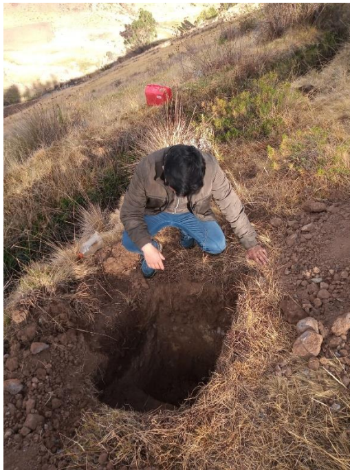
Foto 6. Tomando muestra en calicata N° 5
