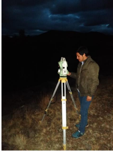
Foto 5. Tomando lectura con láser de estación total a 100m del recervorio
