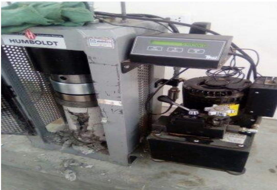
Figura N° 21: ensayo a compresion del CAC
