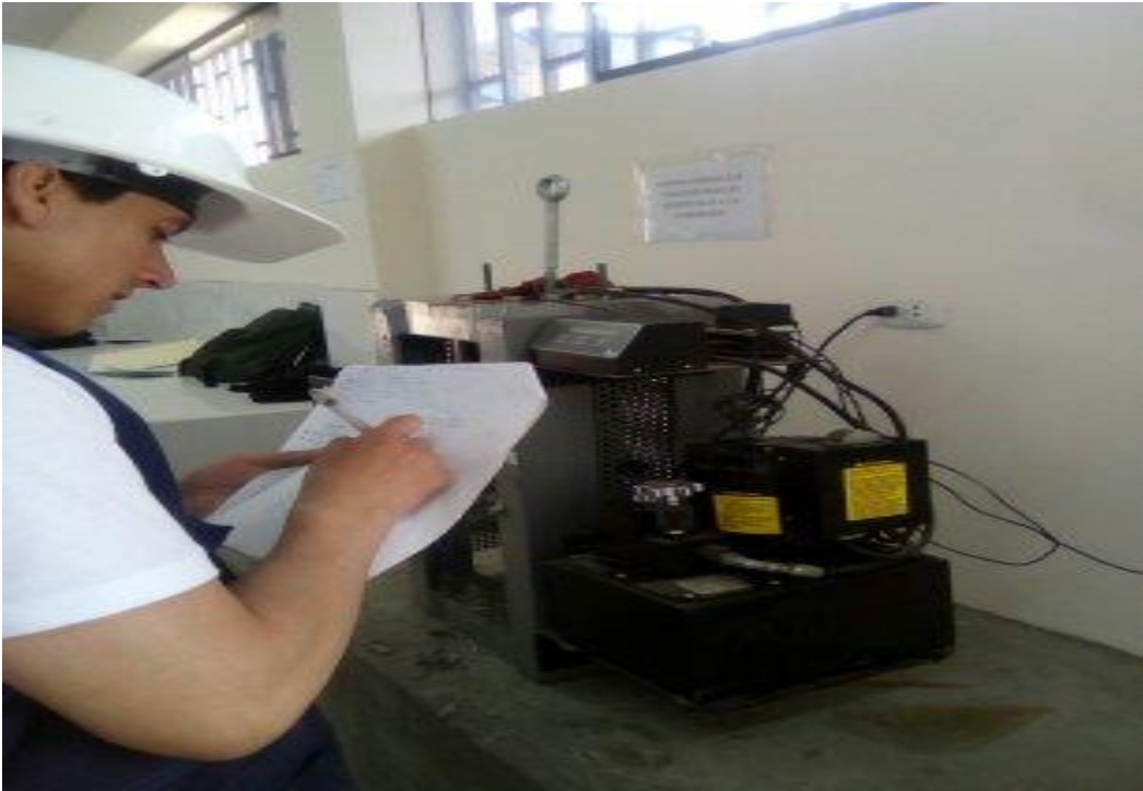
Figura N° 19: Tomando datos del ensayo a compresion del CAC
