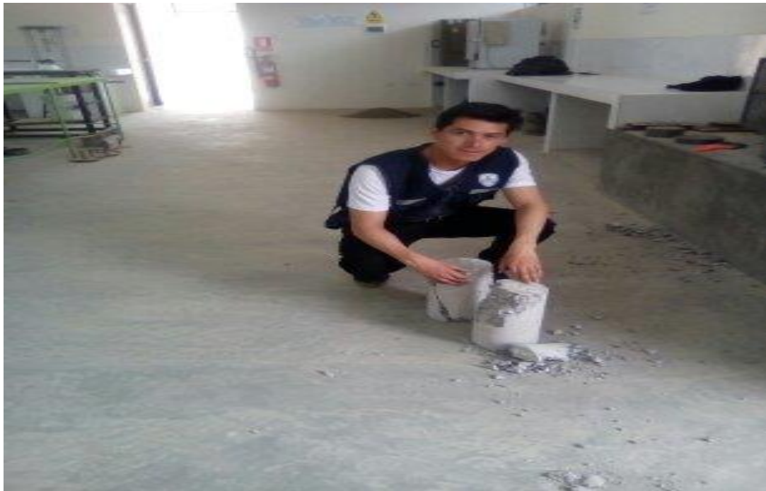
Figura N° 23: rotura de probetas del CAC
