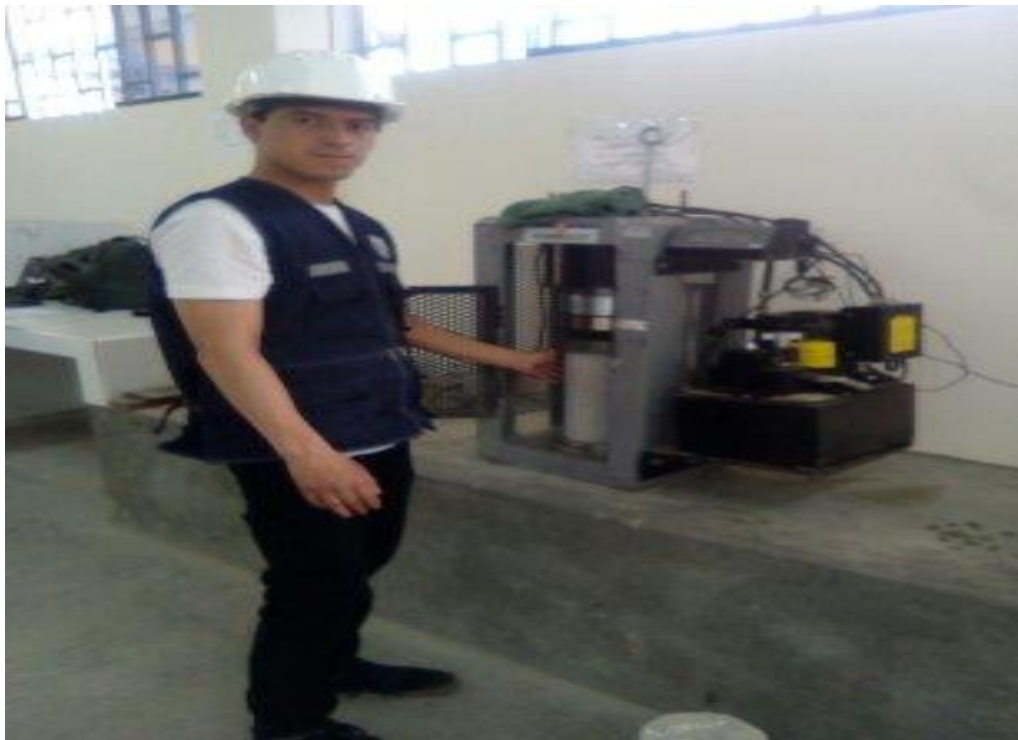
Figura N° 20: ensayo a compresion del CAC
