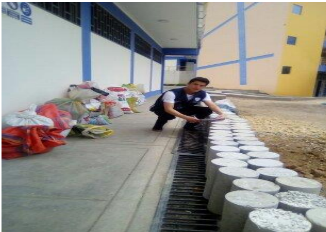
Figura N° 24: producto final del CAC patrón y 2kg/m 3 , 5kg/m 3 de Fibra de acero
