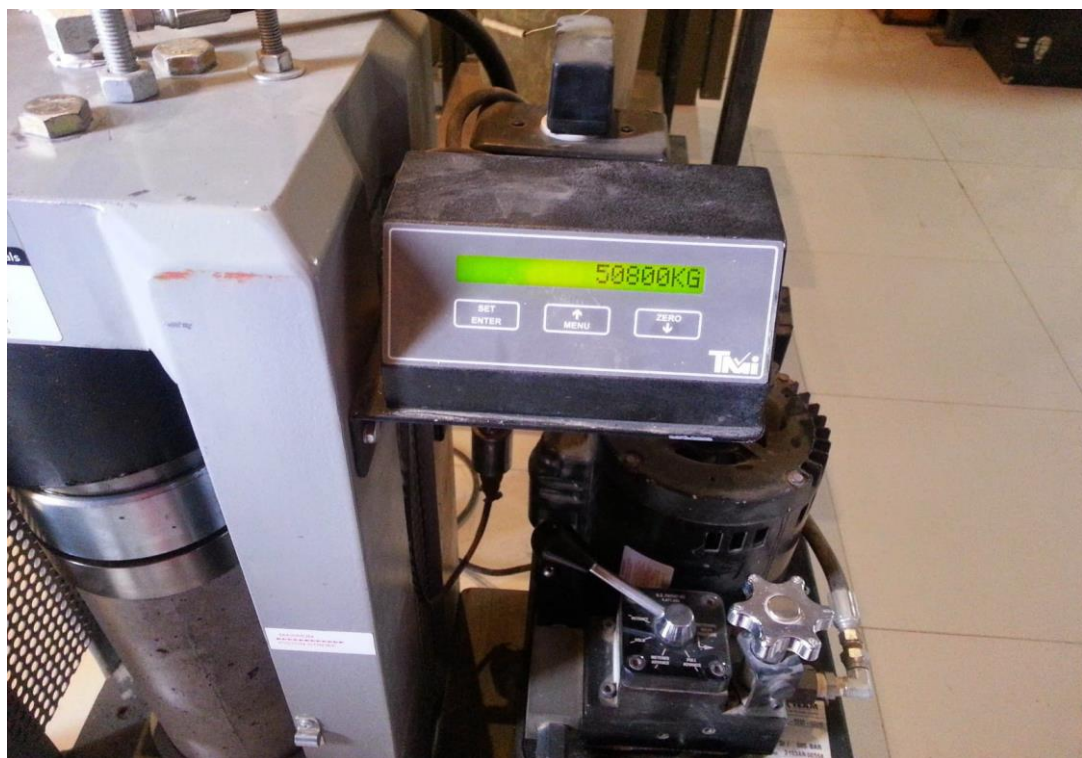
Figura N° 22: ensayo a compresion del CAC
