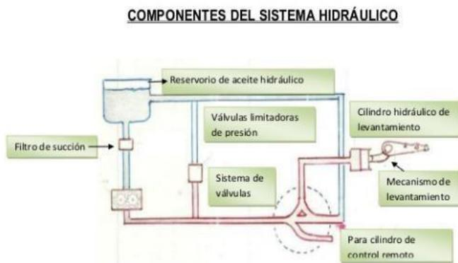
Fig.15: Componentes del Sistema hidráulico
