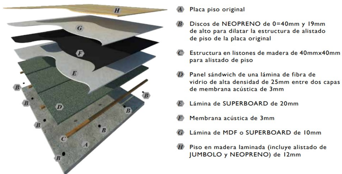
Figura 19. Esquema de aislamiento de pisos flotante. Recuperado de: MINCULTURA (2016)
