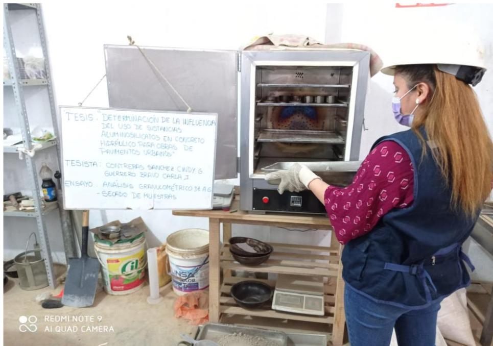
Figura 8. Secado en estufa de agregados para su análisis
