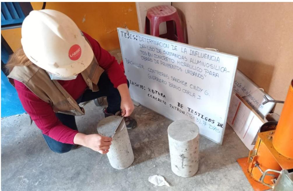
Figura 16. Medición del diámetro de la probeta previas al ensayo mecánico de resistencia a la compresión.
