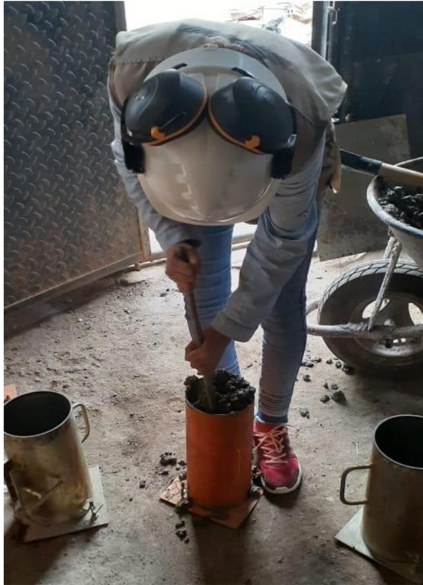
Figura 15. Elaboración de las probetas para ensayos de resistencia mecánica.
