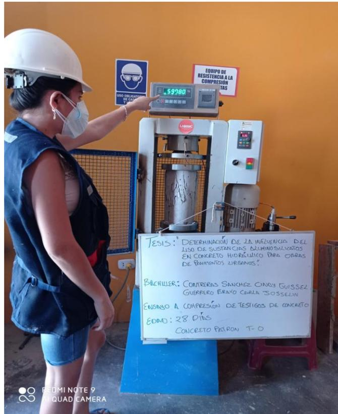
Figura 17. Rupturas de probetas a los 28 días.
