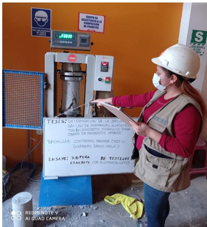
Figura 17. Rupturas de probetas a los 7 días.
