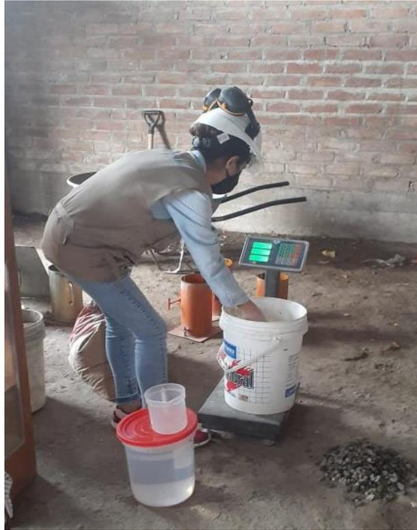
Figura 9. Pesado de los materiales de acuerdo al diseño de mezcla.
