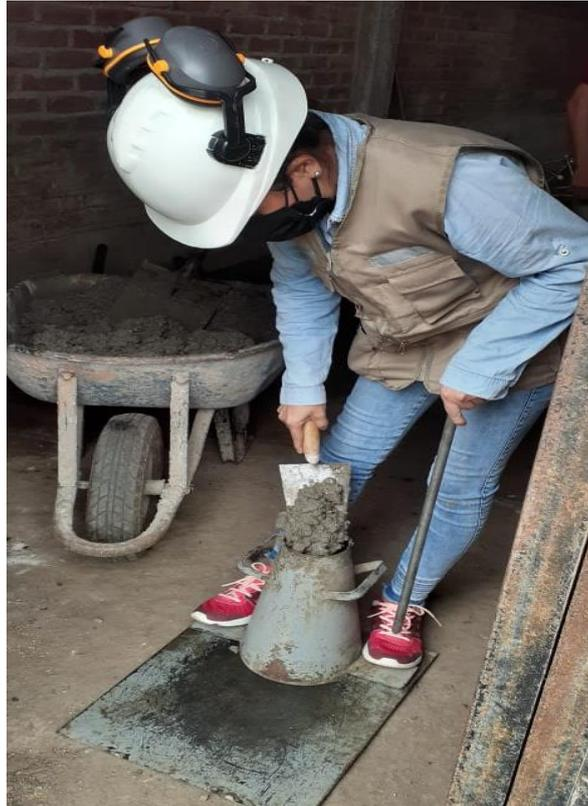
Figura 13. Llenado del cono de Abrams para medir el Slump.
