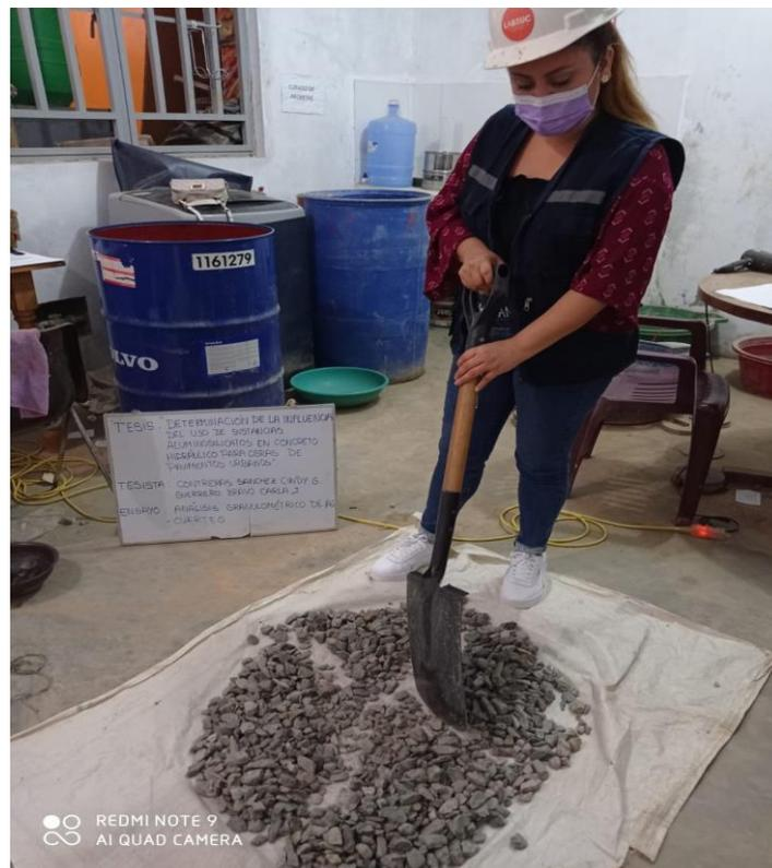
Figura 9. Selección de la muestra de agregado grueso para su análisis
