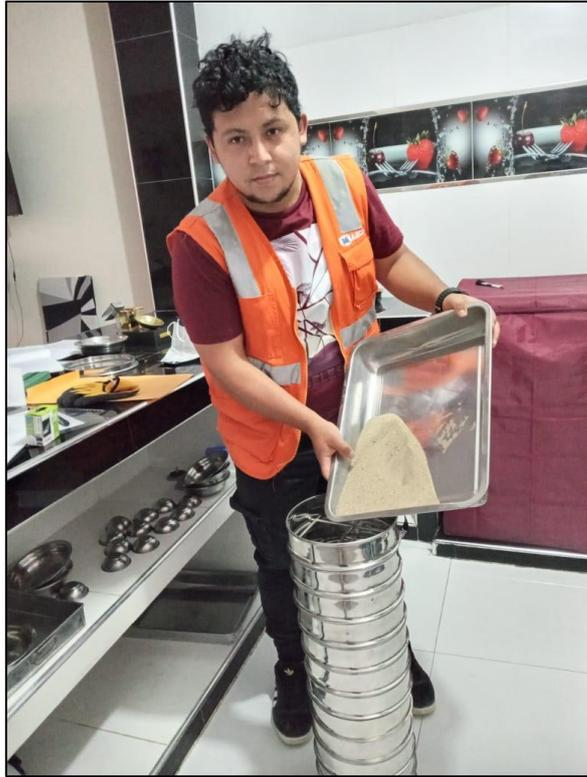
**Figura 07: Tamizado del material.**
