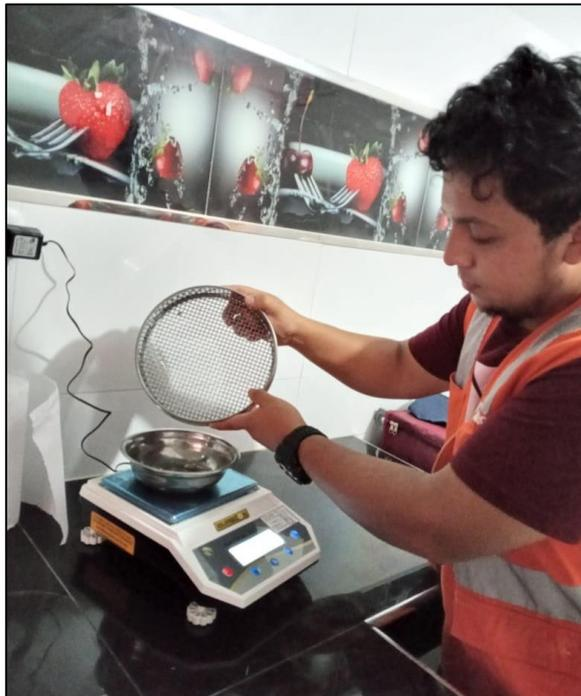
**Figura 08: Pesado del material retenido en los tamices.**
