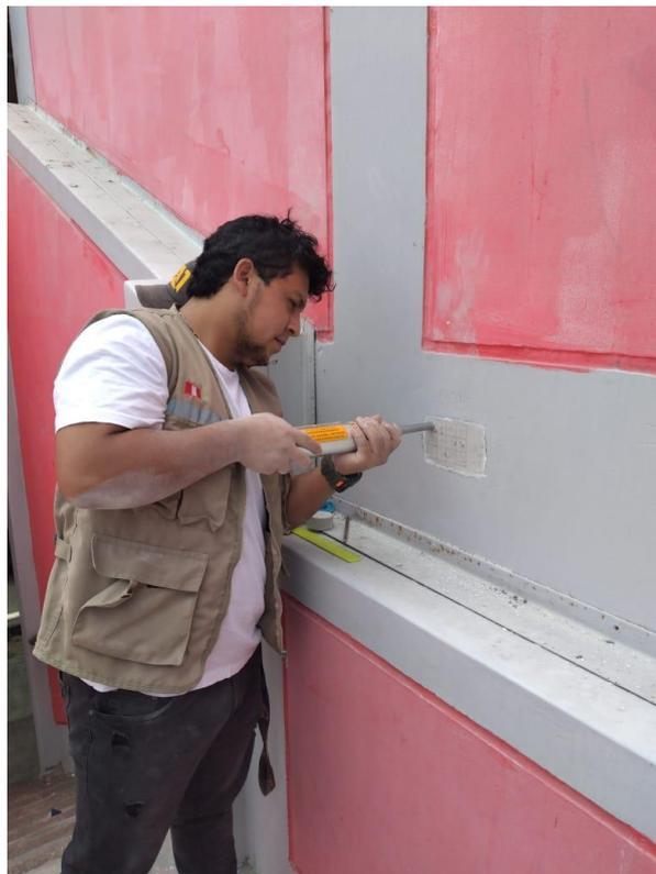
**Figura 14: Ensayo de esclerometría en viga.**
