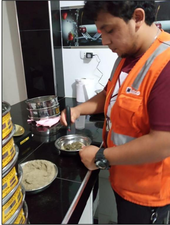
**Figura 09: Preparación del material para ensayo de límites de consistencia.**
