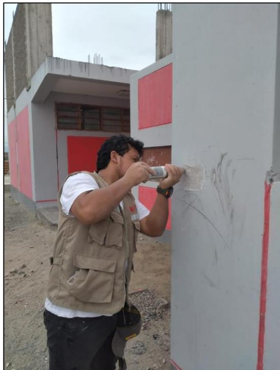
**Figura 12: Ensayo de esclerometría en columna.**
