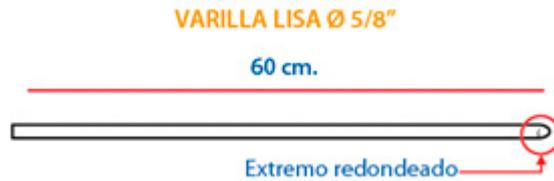
**Figura N°06.** Barra de Acero, Fuente: "SENCICO".
