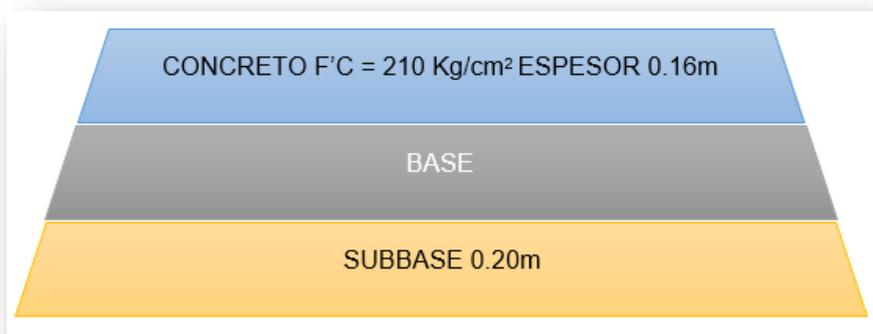
Figura N°30. Espesor para el Diseño de Pavimento.
