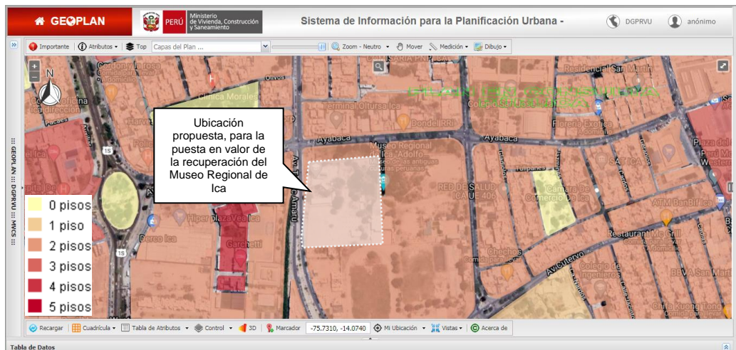
Figura N° 37: Altura de la Edificación
