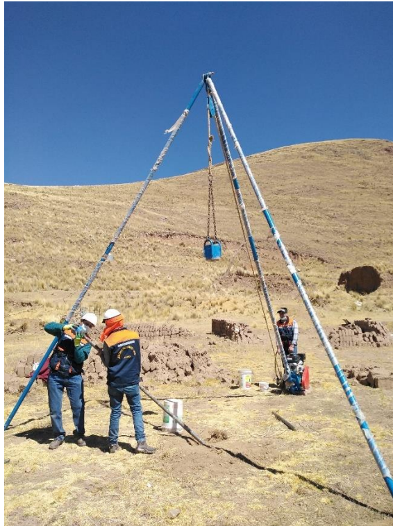
Ensamblado de equipo para ensayo de penetración estándar
