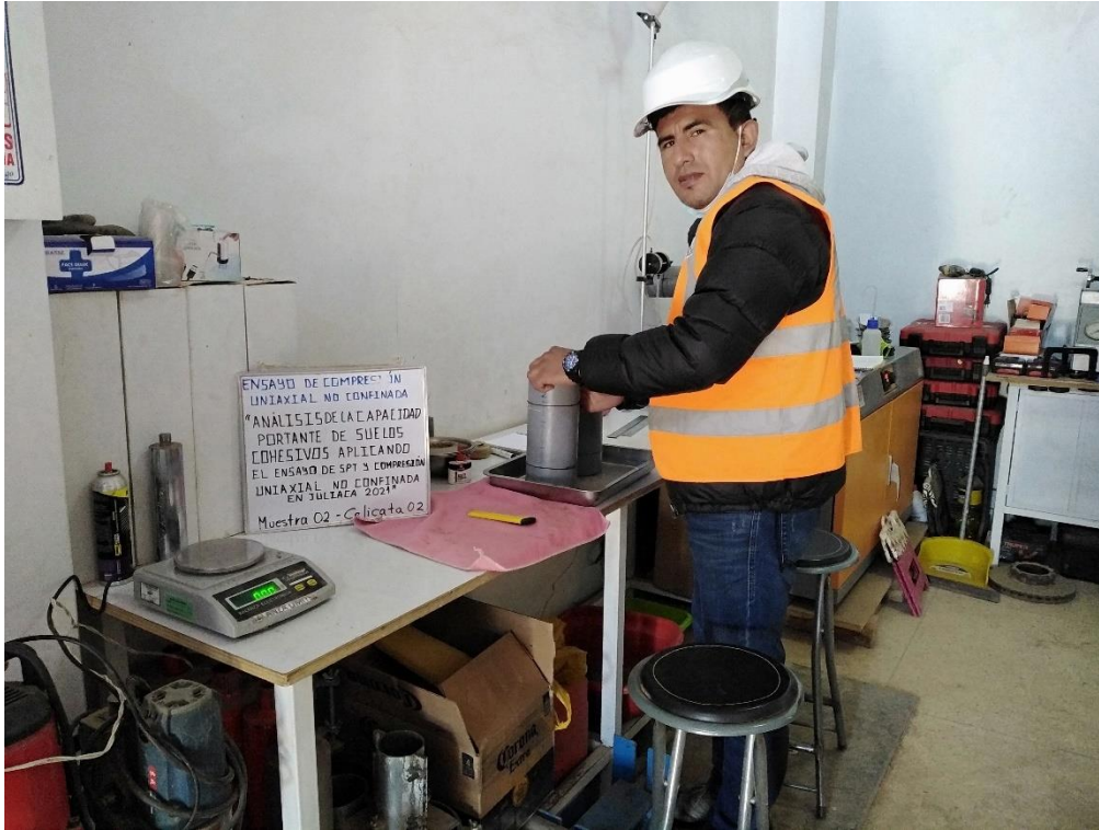
Determinación de la densidad del suelo por volumen
