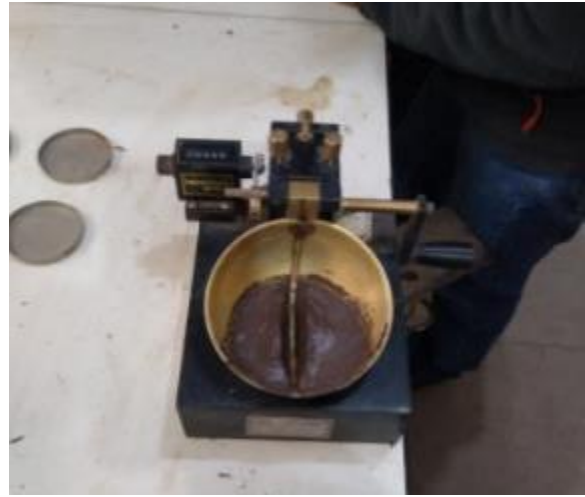
Figura 25. Proceso del LL con la Cuchara de Casagrande.
