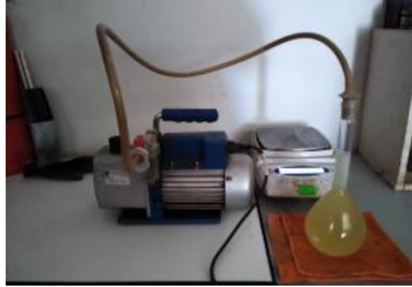
Figura 19. Eliminación de aire con la compresora de succión
