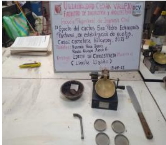
Figura 24. Instrumentos utilizados para el LL.
