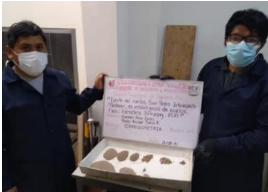
Figura 34. Muestras resultantes del proceso de tamizado
