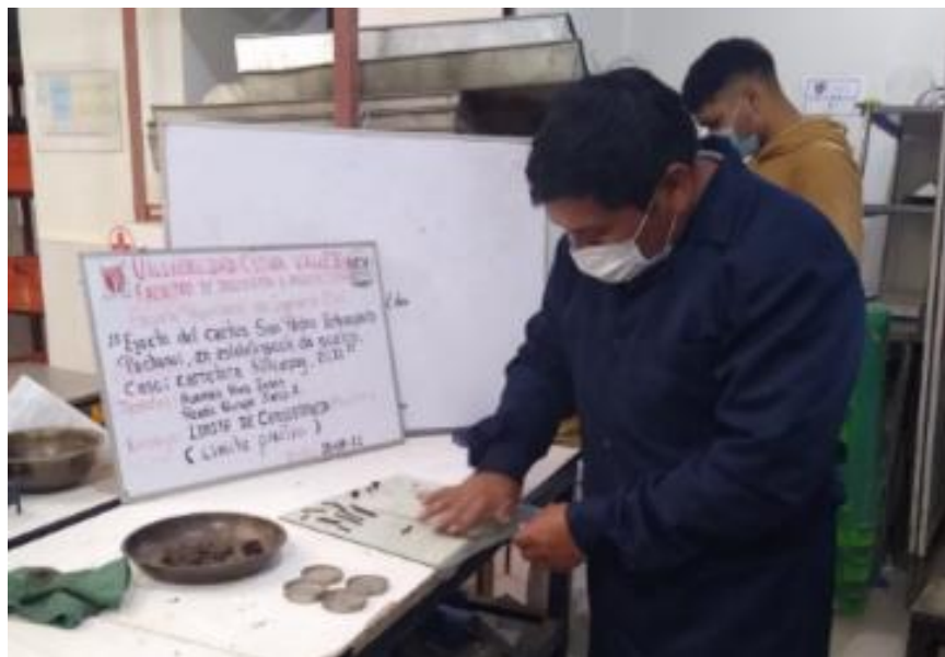
Figura 27. Proceso del Ensayo de Limite Plástico
