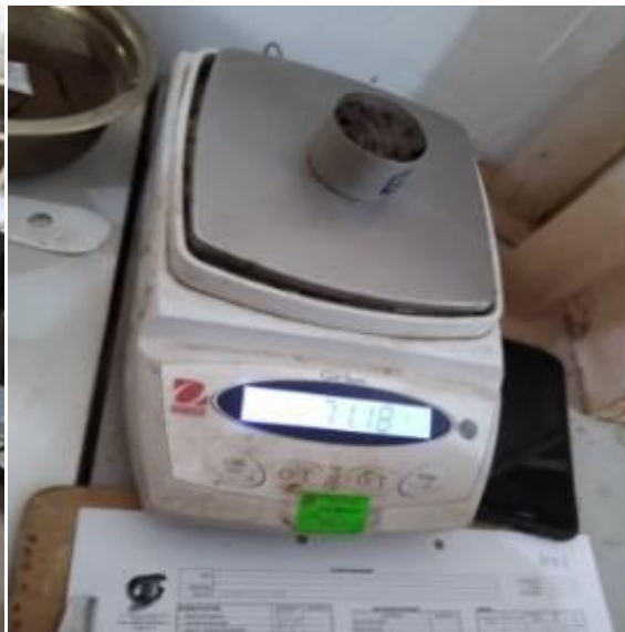
Figura 44. Pesado de la muestra extraída del molde proctor.
