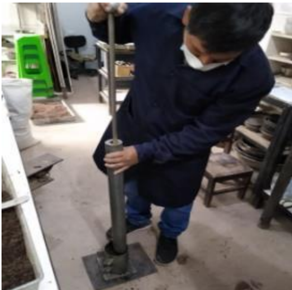
Figura 43. Compactación de suelo en el molde proctor modificado
