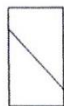
Tipo 4 Fractura diagonal sin fisuras a través de los extremos; golpee suavemente con un martillo para distinguirla del Tipo 1
