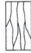
Tipo 3 Fisuras verticales encolumnadas a través de ambos extremos, conos no bien formados
