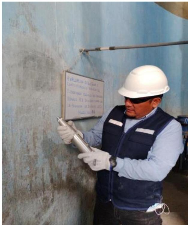
*Fotografía 6. Punto de ensayo de esclerometría en el fuste del reservorio elevado R-3 “Sánchez Cerro” de la provincia de Sullana*
