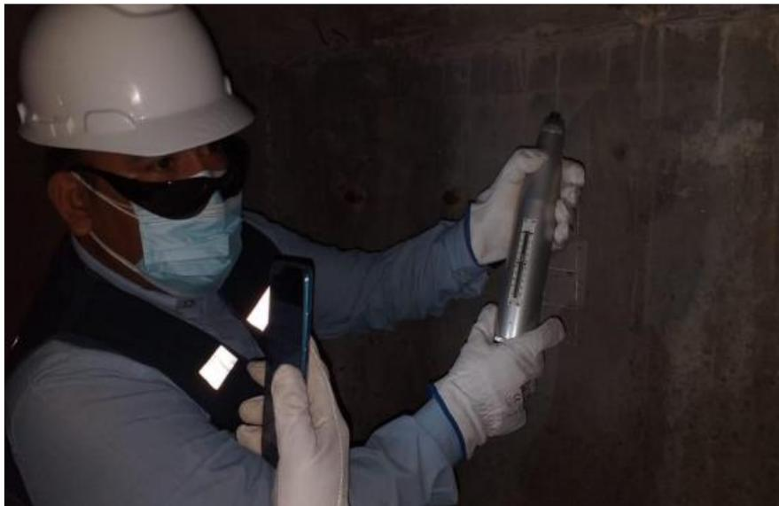
Fotografía 4. Verificación del índice de rebote registrado por el esclerómetro en el reservorio elevado R-3 “Sánchez Cerro” de la provincia de Sullana.
