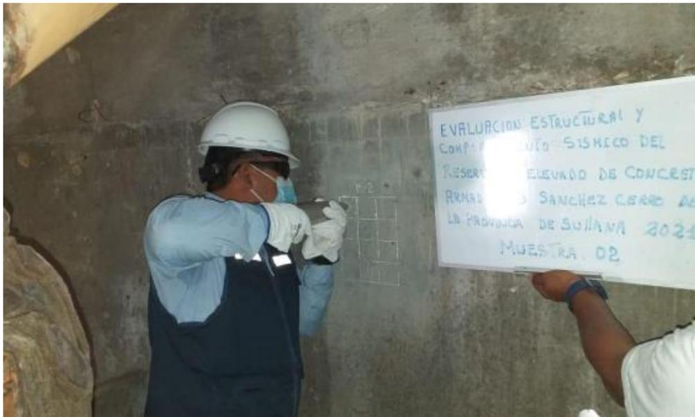
Fotografía 1. Realización de ensayos no destructivos de esclerometría en la cuba del reservorio elevado R-3 “Sánchez Cerro” de la provincia de Sullana.
