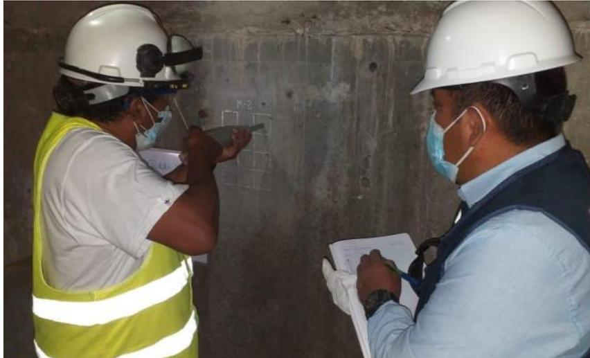
Fotografía 3. Registro del índice de rebote de esclerometría del reservorio elevado R-3 “Sánchez Cerro” de la provincia de Sullana.
