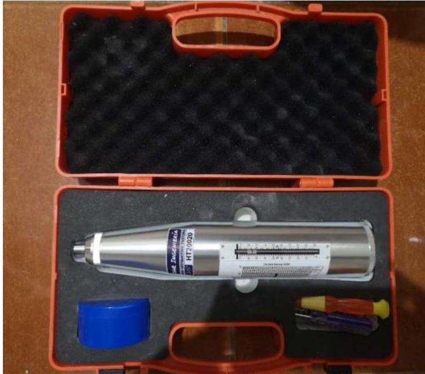
ESCLERÓMETRO MODELO ZC3-A CONCRETE TEST HAMMER (INCLUYE CERTIFICADO DE CALIBRACIÓN)
