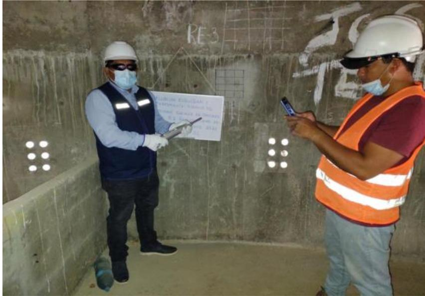
*Fotografía 5. Ensayo de esclerometría en el reservorio elevado R-3 “Sánchez Cerro” de la provincia de Sullana*
