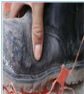
Calzado de seguridad desgastado y roto
