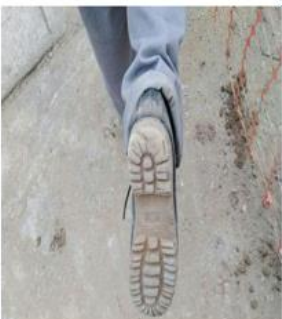
Calzado de seguridad desgastado y roto
