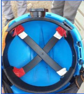
Casco con tafíete en mal estado (Puntos de apoyo roto)
