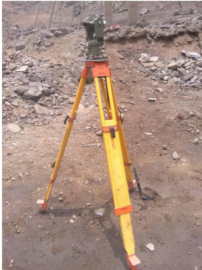
Figura 69. Calibración del equipo, ubicación de la primera estación
