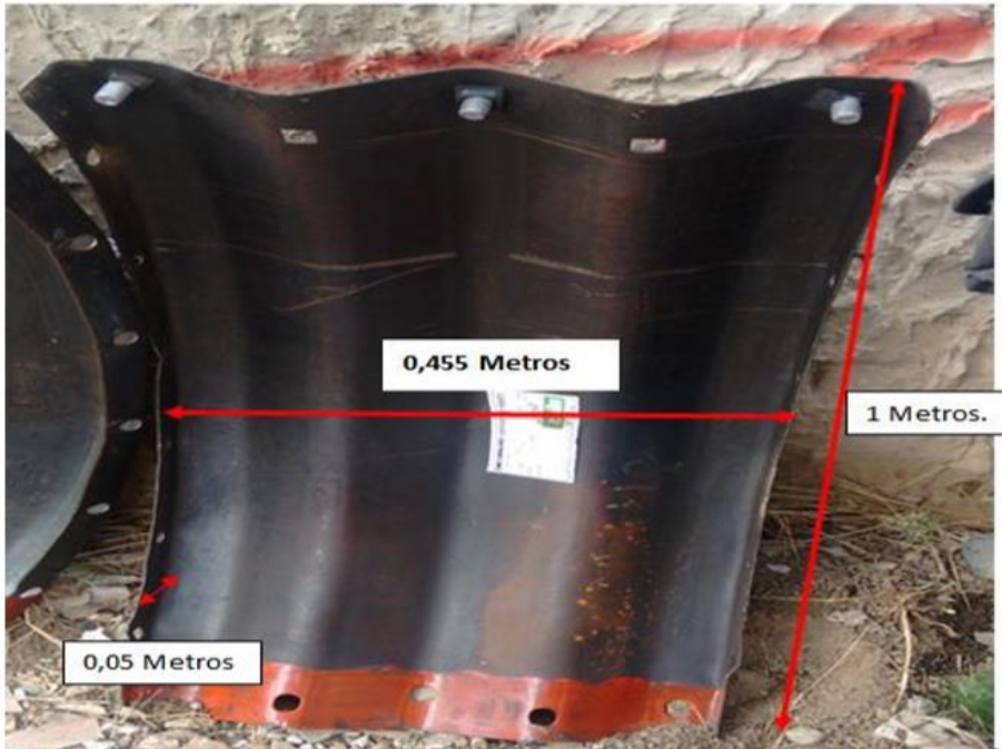
Figura 3. Dimensiones de una lámina de túnel liner Fuente: Tecno Vial, estructura de acero corrugado, 2012
