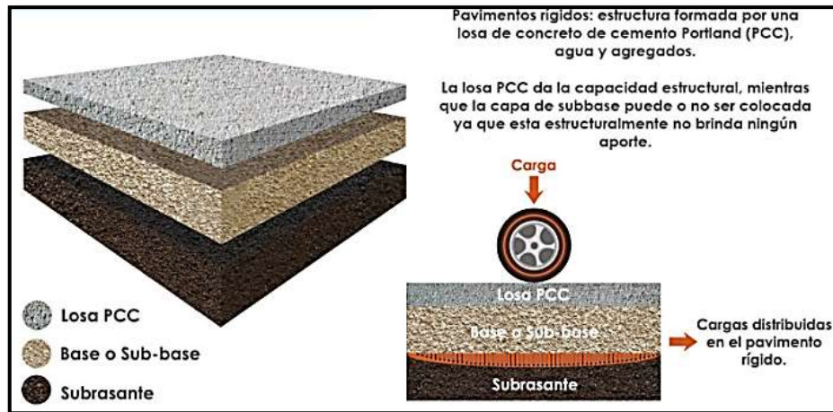
Figura 2. Estructura de un Pavimento Rígido
