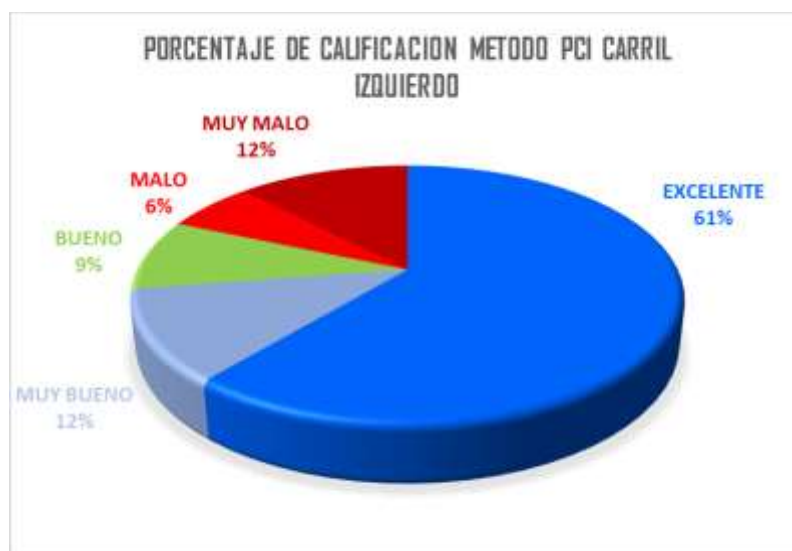
Figura 50. Gráfico de porcentaje de resultados según método PCI en el carril izquierdo
