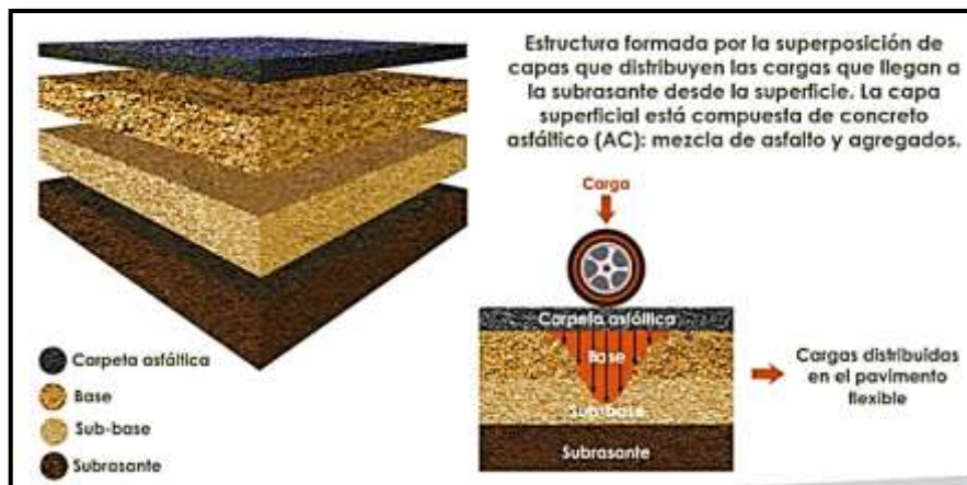
Figura 3. Estructura de un Pavimento Flexible
