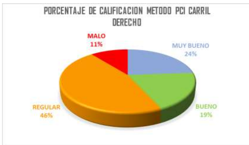
Figura 49. Gráfico de porcentaje de resultados según método PCI en el carril derecho.
