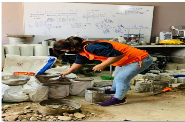
Figura: N° 36 Dosificación de caucho en la muestra de suelo
