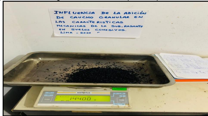
Figura 16: Caucho granular en 2.4% respecto al peso de la muestra
