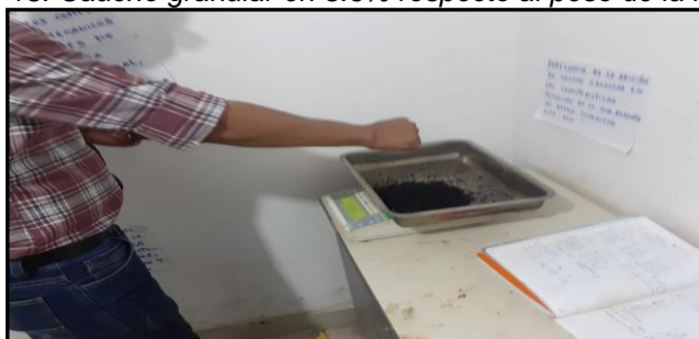
Figura 18: Caucho granular en 3.6% respecto al peso de la muestra
