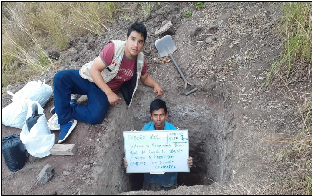
Foto 11. Estudio de suelos – Calicata 1
