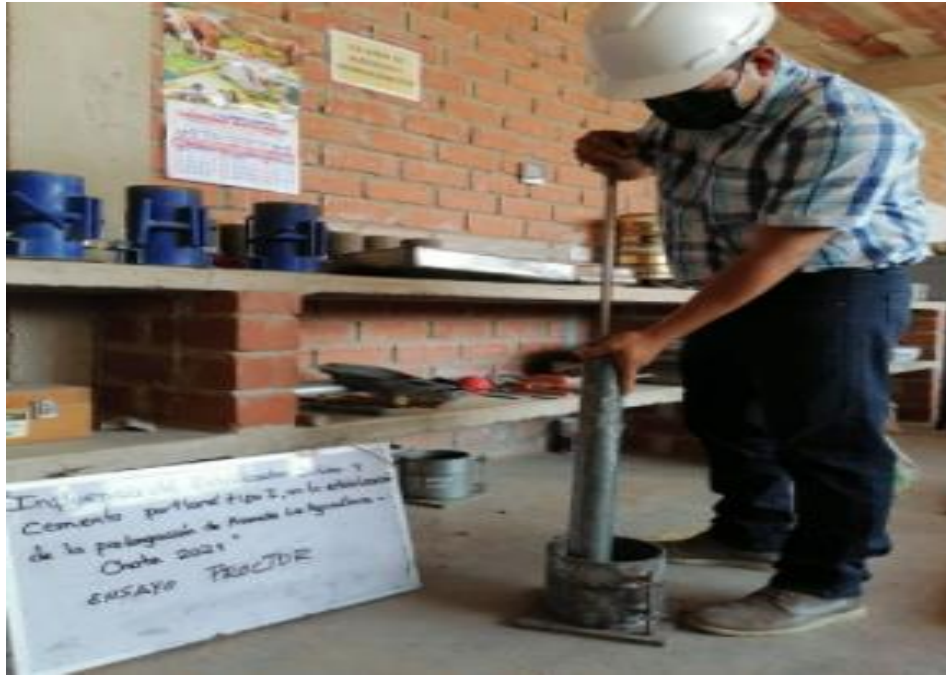
Elaboración de ensayo de Proctor modificado.
