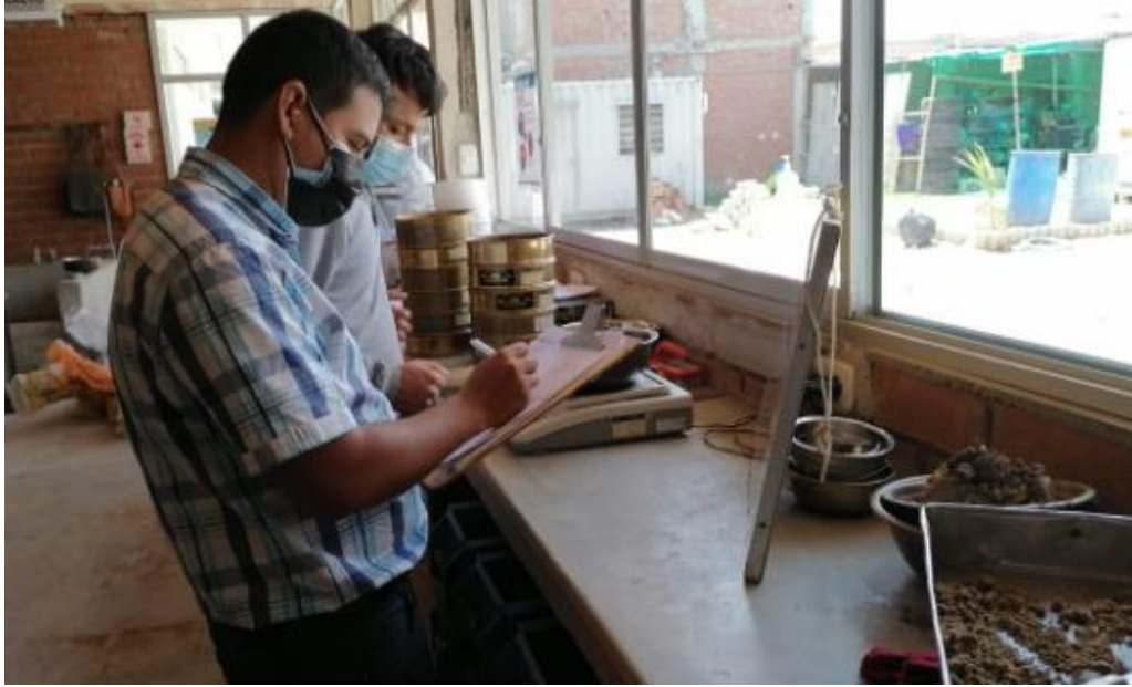
Elaboración de ensayo de Granulometría.
