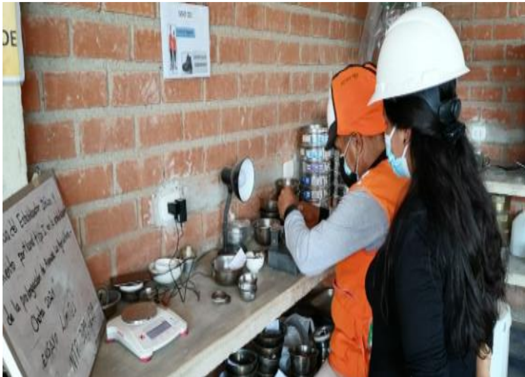
Elaboración de ensayo de límites de consistencia.
