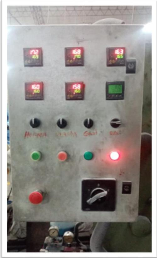
*Tabla 3: datos térmicos de la máquina de termoformado*
