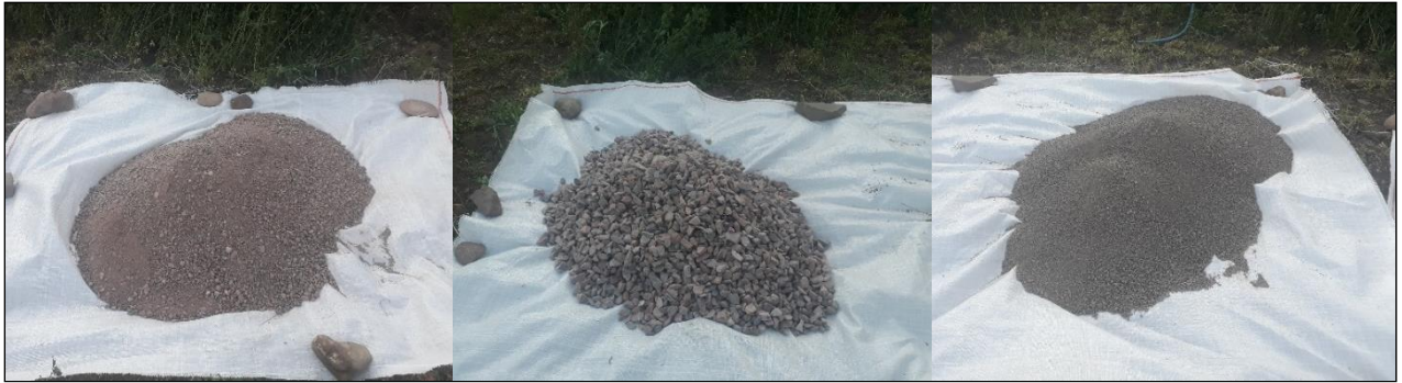
Figura 62. Sustratos (arena gruesa, grava media, grava fina (confitillo)).
