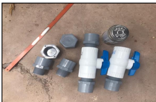
Figura 15. Llaves de paso para los humedales artificiales.
